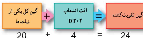
با  $V = 52 \text{ db}/\mu\text{V}$  باشد، می‌بایستی برای سیستم آتن مرکزی یک تقویت کننده مناسب در نظر گرفت. مثلاً تقویت کننده‌ای با گین حدود  $28 \text{ db}$  تا  $30 \text{ db}$  دسی‌بل می‌تواند سیگنال موردنیاز را به خروجی‌های سیستم برساند. بنابراین هنگام تعیین تقویت کننده باید مقدار db خروجی آتن را داشته باشیم تا توانیم سیستم مناسبی را طراحی کنیم.
