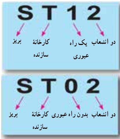
**مثال ۱-۴:** اگر دسی بل بر میکروولت ورودی به پریز در محدوده فرکانس  $47\text{--}86\text{ MHz}$  مگاهرتز برای تلویزیون برابر  $57$  باشد، مقدار گین در خروجی های عبوری و انشعابی پریز چند دسی بل است؟
