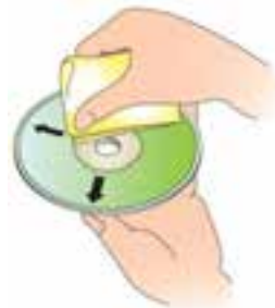
شکل ۶۵-۲ استفاده از پارچهٔ تمیز جهت پاک کردن دیسک
