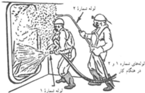
شکل ۲-۶ نحوه خاموش کردن آتش به وسیله دو لوله
