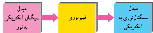
شکل ۲-۸- اساس یک سیستم فیبر نوری
