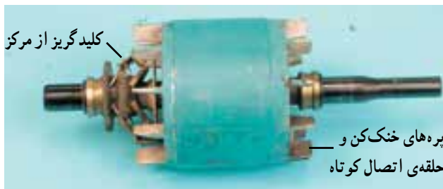
شکل ۶-۸ - روتور یک موتور کولر با پره‌های خنک‌کن و کلید گریز از مرکز
