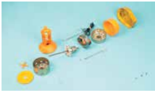
شکل ۱۸-۸ - نمایش ظاهری و اجزای یک واترپمپ
