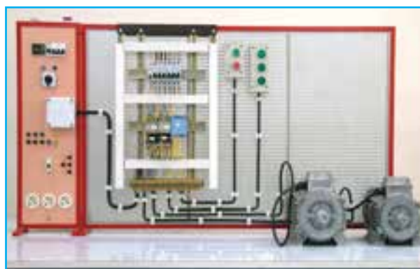
شکل ۳-۲- راه اندازی دو موتور آسنکرون سه فاز به صورت یکی پس از دیگری با تایمر
