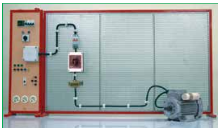
شکل ۱-۳- راه اندازی موتور تک فاز با کلید چپ گرد، راست گرد زیانه‌ای
