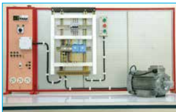
شکل ۳-۴- راه اندازی موتور سه فاز آسنکرون به صورت چپ گرد، راست گرد بدون توقف (سریع) با تایمر
