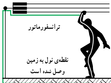
شکل ۸-۲ نحوه‌ی عبور جریان از بدن شخص برق گرفته
