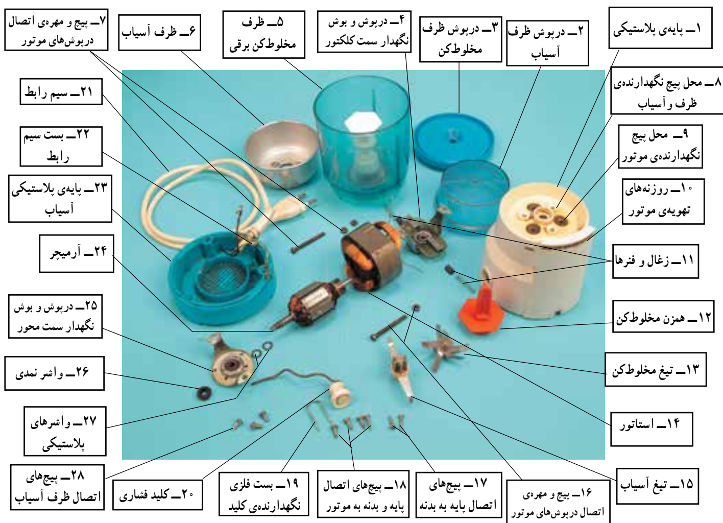
شکل ۴-۳۲- اجزای ساختمانی یک نمونه مخلوط‌کن برقی
