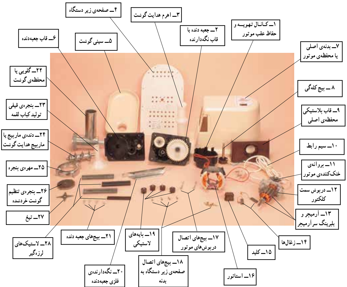
شکل ۳-۴۸- اجزای ساختمانی یک نمونه چرخ گوشت
