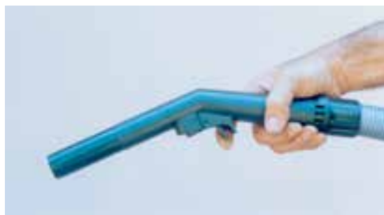
● شکل ۷-۲ زانویی را نشان می‌دهد که دارای کلیدی است که اگر زده شود قسمتی از هوای مکش موتور از زیر آن خارج می‌شود و مکش پرس را تنظیم می‌کند.
