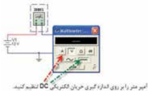
شکل ۱۴-۶ تنظیم آمپر متر روی حالت DC
