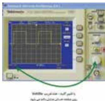
شکل ۴۸-۶ تغییر کلید Volt/Div و نمایش شکل موج
