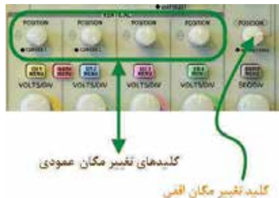
شکل ۶-۴۳ کلیدهای تغییر مکان افقی و عمودی
