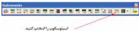
شکل ۳۳-۶- انتخاب دستگاه اسیلوسکوپ از نوار ابزار
