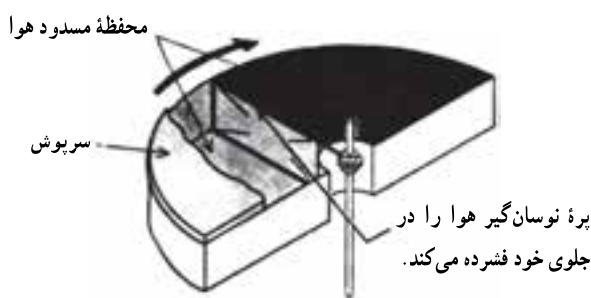
شکل ۳۵-۵- حرکت محور باعث گردش عقربه و پره می شود. به تدریج که هوا در قسمت جلوی محفظه فشرده می شود عقربه با مانع برخورد می کند. این موضوع باعث کند شدن عقربه و در نتیجه کاهش نوسانات می شود.
