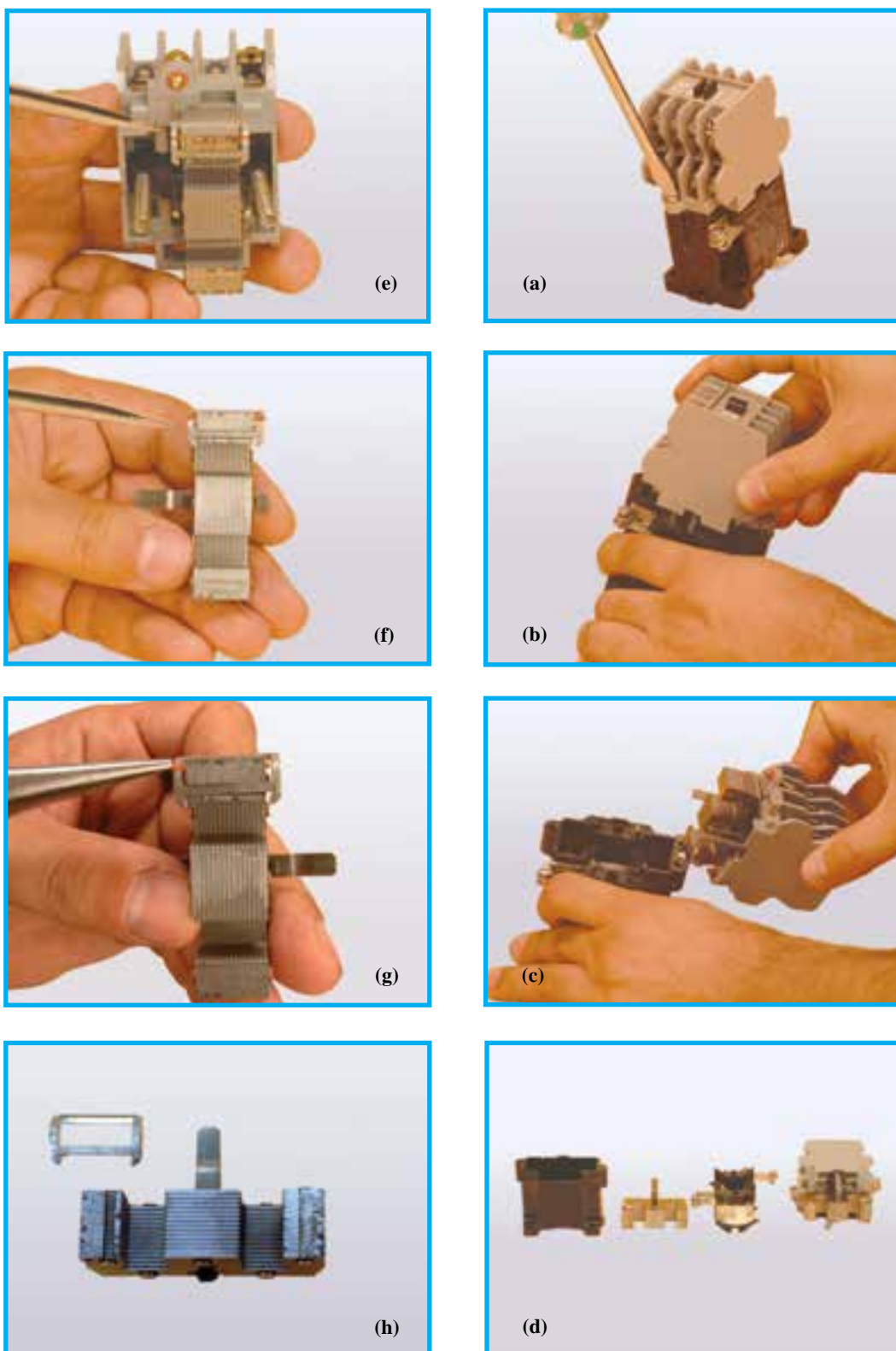
شکل ۳-۴- مراحل باز کردن اجزای تشکیل دهنده کنتاکتور
