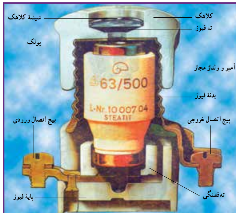
شکل ۱۵-۴- نمای بُرش خورده فیوز فشنگی
