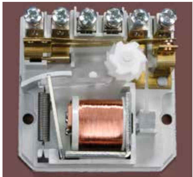
شکل ۳۴-۵ نمای داخلی رله‌ی ضربه‌ای
