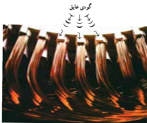
شکل ۲۰-۶ محکم کردن سیم‌ها در داخل شیار با گونه‌ی عایق
