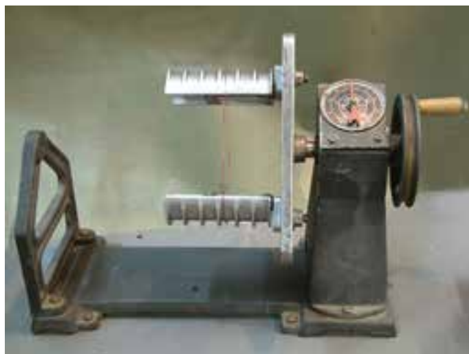
شکل ۹-۶- طریقه‌ی اندازه‌کردن بوبین در کلاف پیچ
