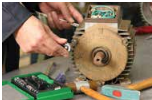
الف- باز کردن پیچ‌های موتور
