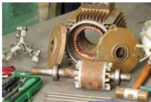
ت- جدا کردن قطعات موتور
