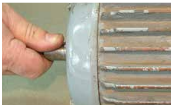
شکل ۳۰-۶ - آزمایش لنگی (لقی) بوش‌ها یا بلبرینگ‌ها
