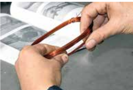
شکل ۱۶-۶- مرتب کردن سیم‌ها جهت کلاف گذاری
