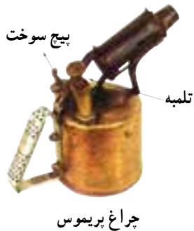
شکل ۳-۴ هویه‌ی ساده و دستگاه گرم‌کننده‌ی آن
