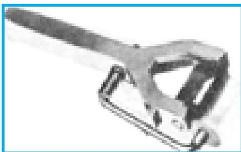
شکل ۲-۱۶- وسیله روش برداری کابل
