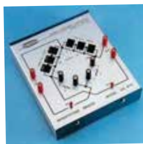
شکل ۲-۳۰- یک نمونه پل وتستون
