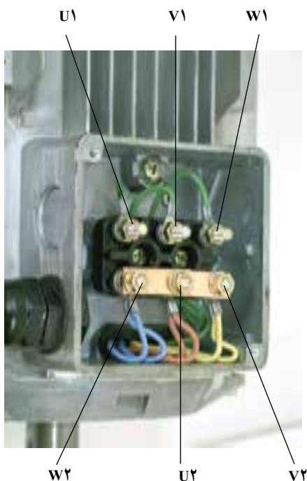
شکل ۱۸-۱ اتصال ستاره روی تخته کلم موتور
