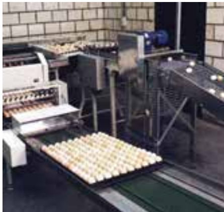
تصویر ۴-۵- انتقال تخم مرغ به شانه‌ی جوجه کشی با روش تمام خودکار
