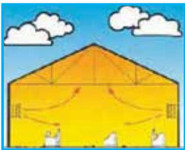
تصویر ۱-۲- مقایسه‌ی سیستم‌های گرمایشی جابه‌جایی و تابشی
