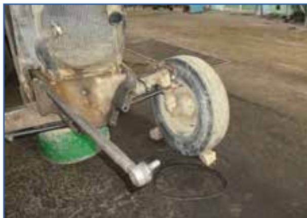
شکل ۱۹-۳ قسمت جلوی تراکتور جدا شده از موتور
