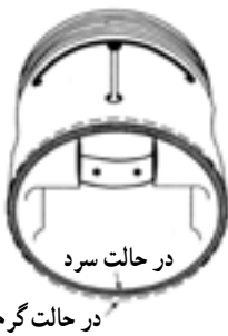
شکل ۱۹-۲ وضعیت پیستون در حالت گرم و سرد
