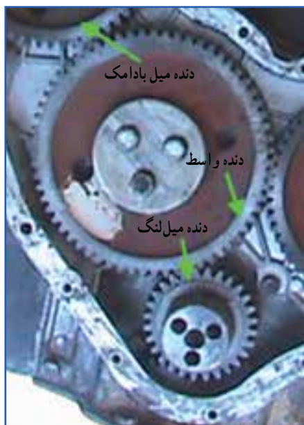
شکل ۱۲-۲- نسبت دنده میل بادامک به میل لنگ
