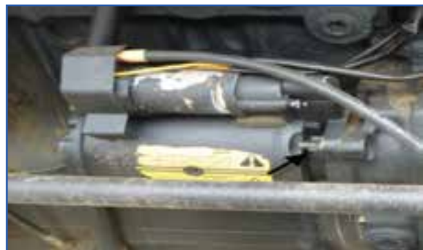
شکل ۳-۸ پیچ های نگه دارنده استارت تراکتور MF285
