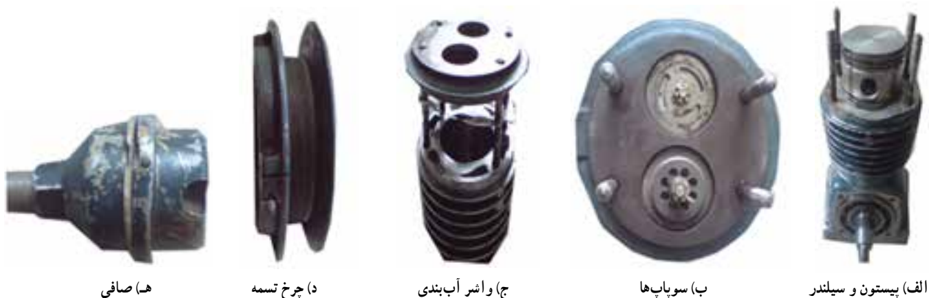
شکل ۳-۸- اجزای کمپرسور باد
