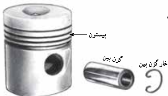
شکل ۳۰-۲- انگشتی و محل نصب آن روی پیستون
