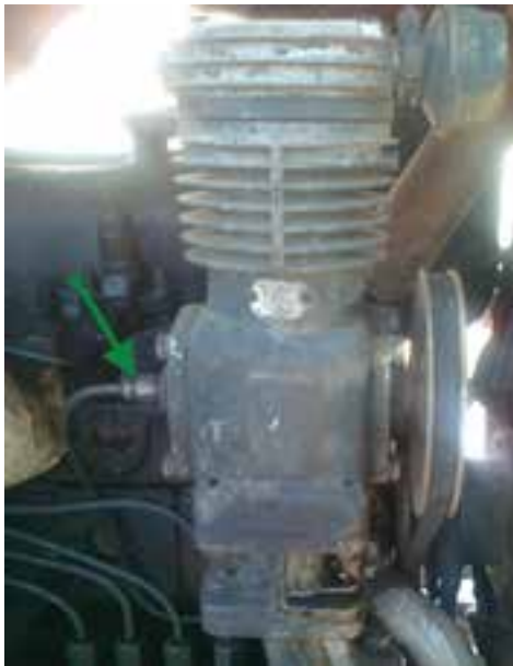
شکل ۵-۸- لوله روغن کاری کمپرسور در تراکتور U650
