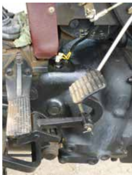
شکل ۱۱-۳ پیچ‌های اتصال موتور به جعبه‌دنده قسمت پایین
