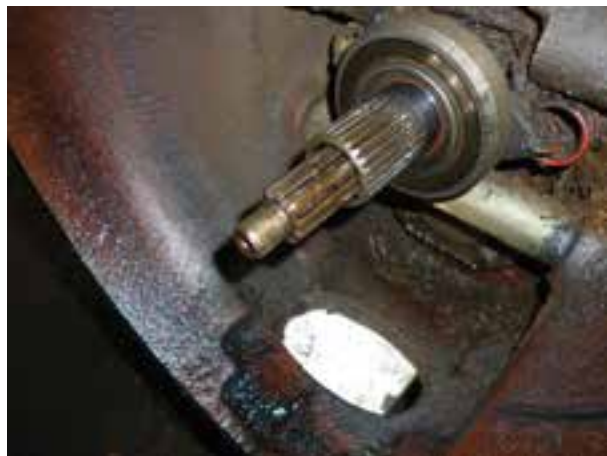
شکل ۱۳-۳ شافت ورودی جعبه‌دنده
