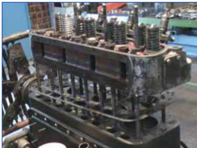
شکل ۲-۵- وضعیت قرار گرفتن واشر سرسیلندر
