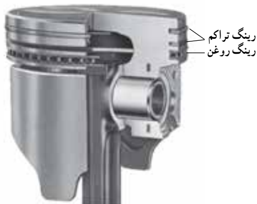
شکل ۲۲-۲- انواع رینگ روی پیستون
