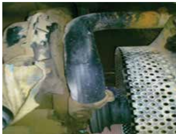
شکل ۱۵-۳- اتصال شیلنگ رادیاتور
