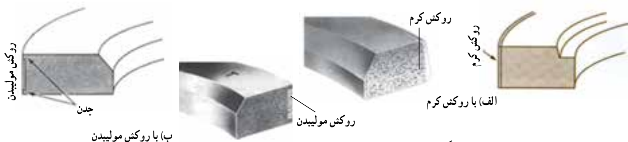
شکل ۲۴-۲- مقطع رینگ‌های تراکم روکش‌دار
