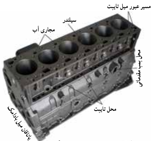
شکل ۱۶-۲ بدنه سیلندر و اجزای آن
