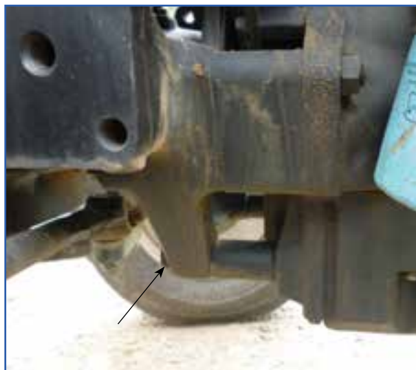
شکل ۱۷-۳- محل پیچ‌های اتصال موتور به جلوی تراکتور
