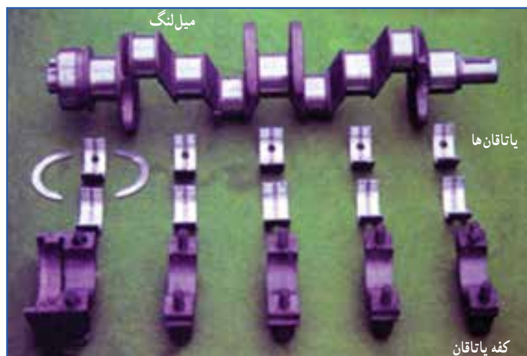
شکل ۳۹-۲ میل‌لنگ، یاتاقان‌ها و کفه یاتاقان‌های ثابت
