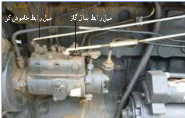
شکل ۳-۴ میل رابط پدال گاز و میل رابط خاموش کن
