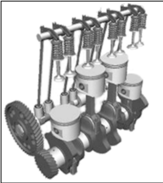
شکل ۸-۲ — قطعات مکانیزم باز و بسته شدن سوپاپ‌ها
