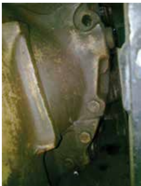
شکل ۱۱-۳ پیچ‌های اتصال موتور به جعبه‌دنده قسمت پایین
