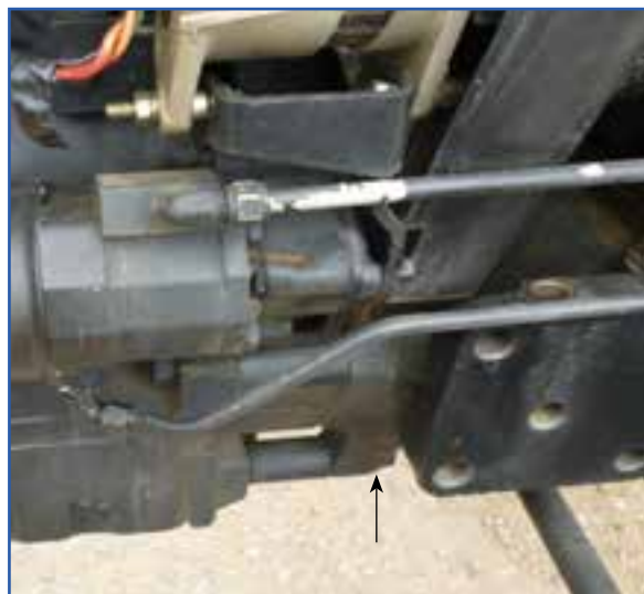
شکل ۱۷-۳- محل پیچ‌های اتصال موتور به جلوی تراکتور
