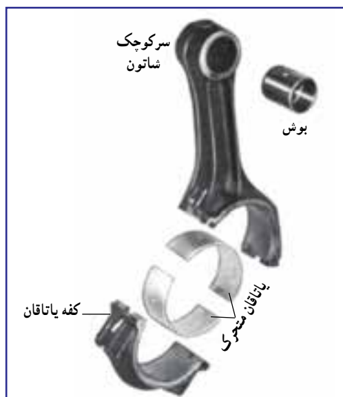
شکل ۲۹-۲- اتصال کفه به شاتون
