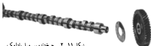
شکل ۱۱-۲ — چرخ‌دنده سر میل بادامک
