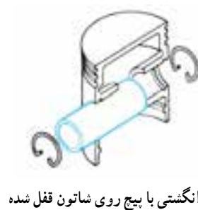
شکل ۳۱-۲- انواع اتصال انگشتی به پیستون
