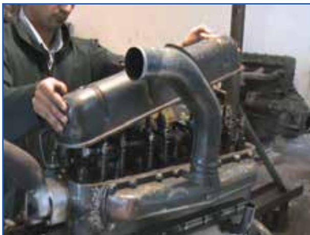
شکل ۴۰-۷ برداشتن قالباق سوپاپ
