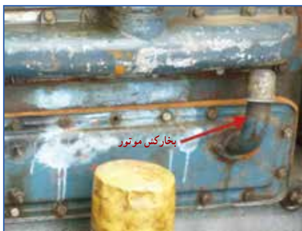
شکل ۲۶-۷- تهویه محفظه کارترو تراکتور U650M
