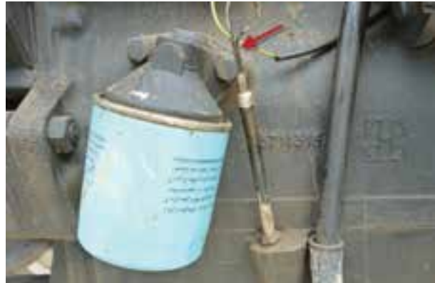
شکل ۳۰-۷ میله سنجش سطح روغن تراکتور MF285
