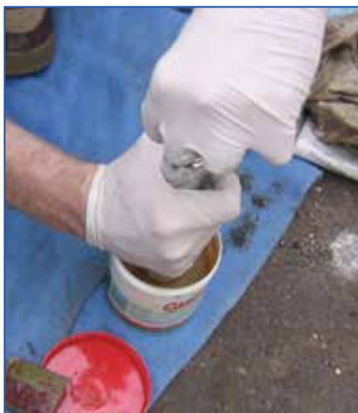
شکل ۴۸-۷- مراحل پر کردن گریس پمپ دستی
