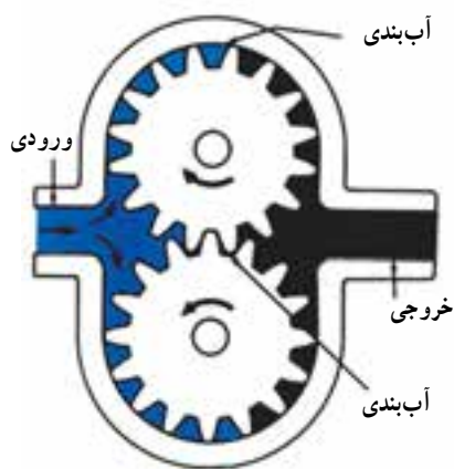
شکل ۱۹-۷- پمپ روغن چرخ دنده‌ای
