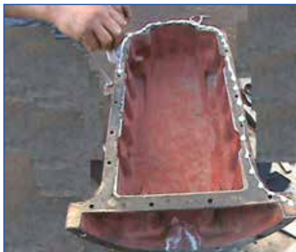
شکل ۳۲-۷ چسب زدن به محل قرارگیری واشر کارتر
