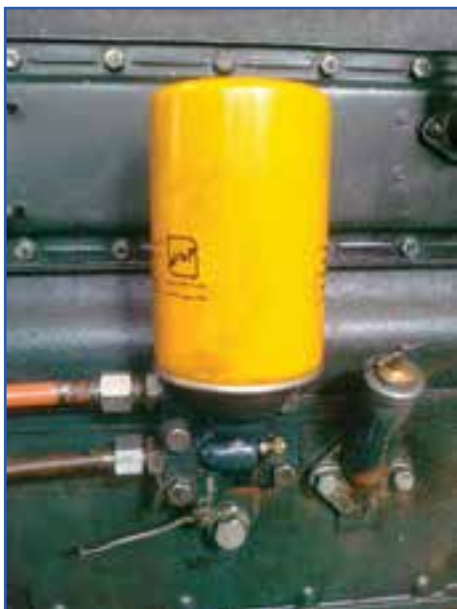
شکل ۱۸-۷ صافی روغن تراکتور U650M
