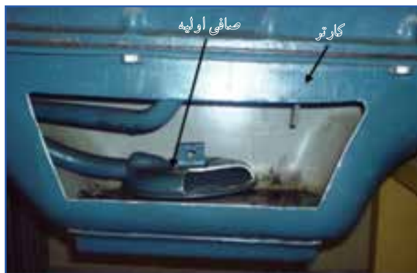
شکل ۲۴-۷- کارترو برش خورده تراکتور U650
