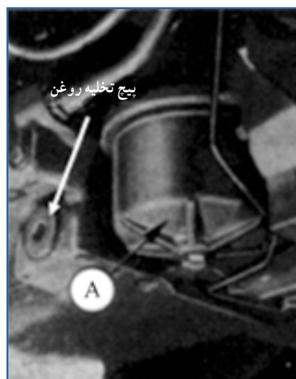
شکل ۷-۵۷ صافی روغن هیدرولیک در تراکتور جاندیر
