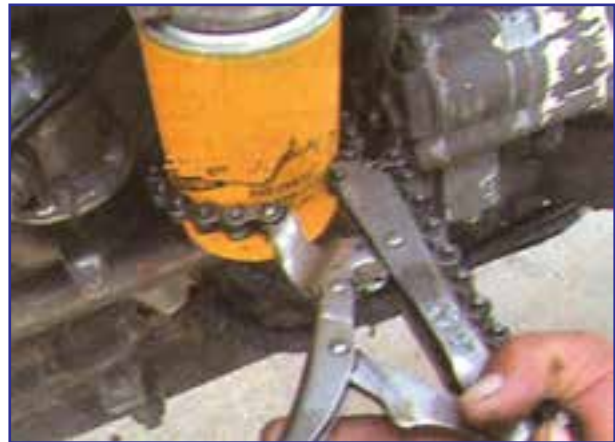
شکل ۱۶-۷ باز کردن صافی روغن با آچار مخصوص
