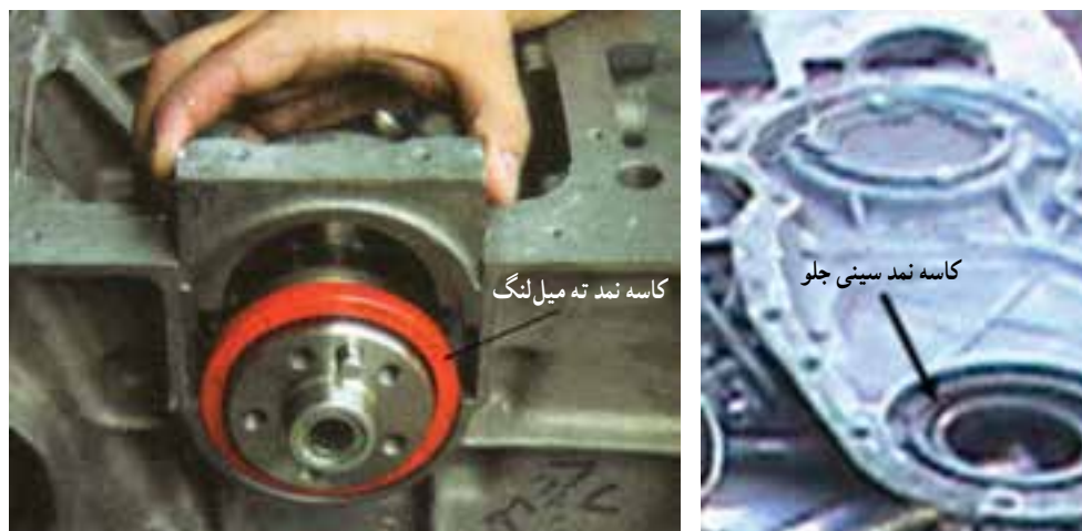
شکل ۳۹-۷- کاسه نمد سر و ته میل‌لنگ
