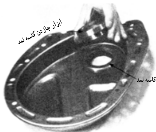
شکل ۴۳-۷- نحوه جازدن کاسه نمد روی سینی جلو
