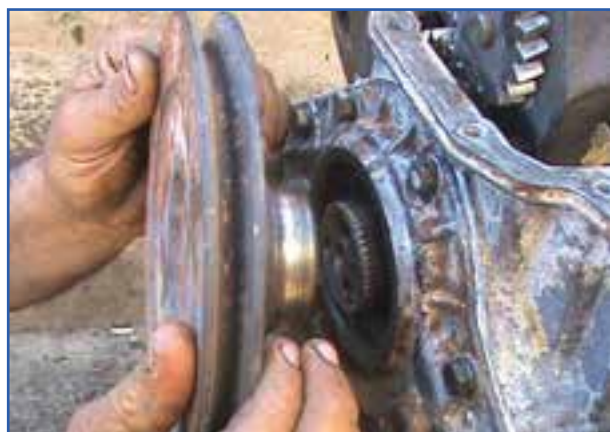
شکل ۴۶-۷- جازدن چرخ تسمه سر میل لنگ
