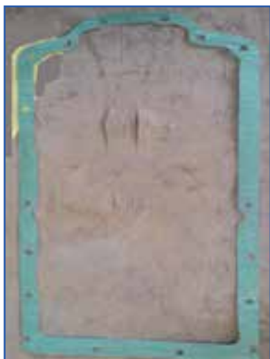
ب) واشر کارتر چوب پنبه ای MF285
