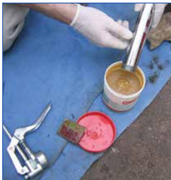
شکل ۴۸-۷- مراحل پر کردن گریس پمپ دستی
