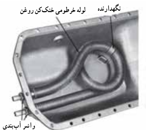
شکل ۳۳-۷ لوله ماریج آب در کارتر تراکتور جاندیر
