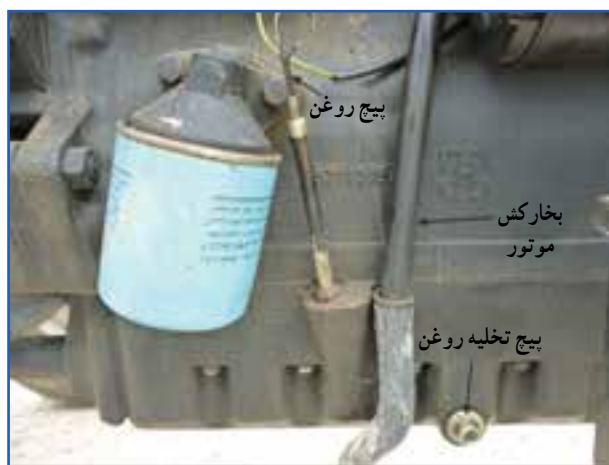
شکل ۲۷-۷ پیچ تخلیه روغن کارتر MF285
