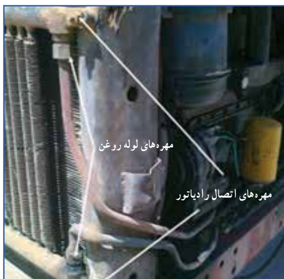
شکل ۳۸- ۷- مهره های لوله روغن سمت رادیاتور روغن
