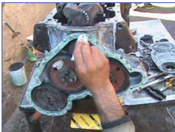
شکل ۴۴-۷- چسب زدن به محل نصب سینی جلو
