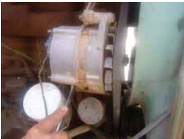
شکل ۳۹-۶ سفت کردن پیچ پایه
