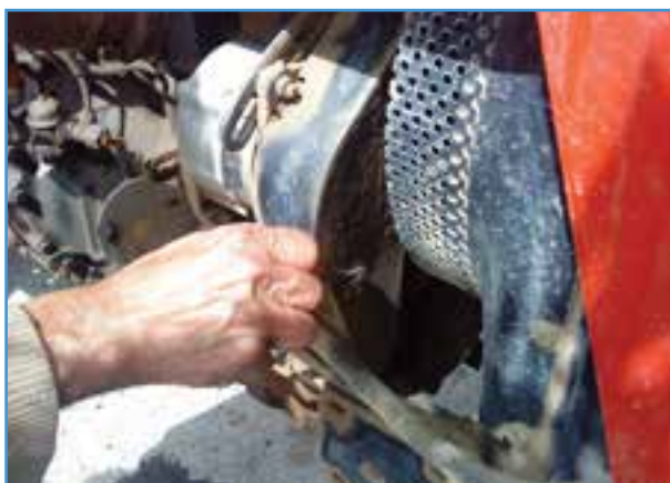
شکل ۳۲-۶ باز کردن روکش محافظ تسمه
