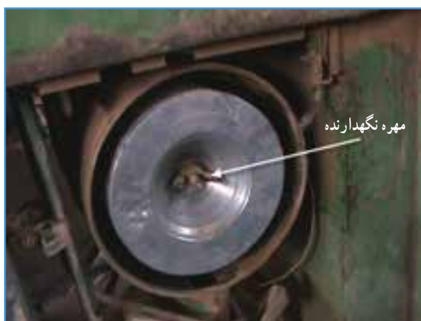
شکل ۱۰-۵ باز کردن شبکه بغل
