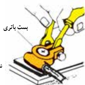
شکل ۶-۶ باز کردن پیچ و مهره بست باتری
