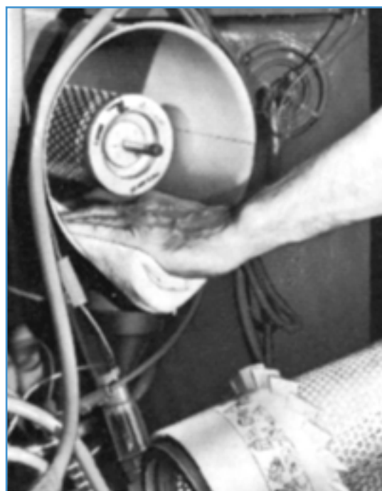
شکل ۱۳-۵ تمیز کردن بدنه صافی با پارچه
