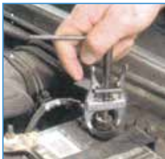
شکل ۶-۷ جدا کردن بست منفی باتری
