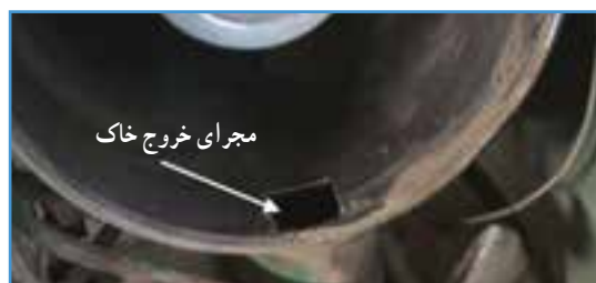
شکل ۱۱-۵ محل خاکدان در تراکتور جاندیر
