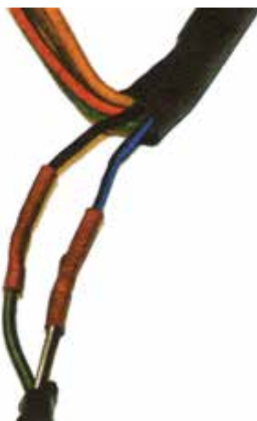
شکل ۶۷-۶- اتصال کامل سیم ها با روکش تیوب عایق
