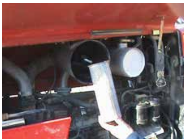
الف) خارج کردن صافی ثانویه
