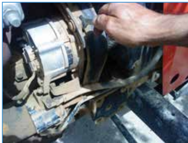
شکل ۲۹-۶ شل کردن پیچ و مهره تنظیم
