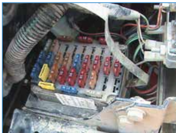
الف) جعبه فیوز (تراکتور MF399)
