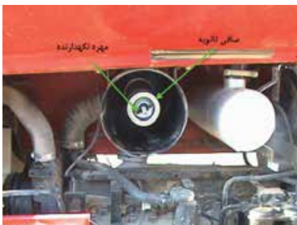
ب) محل قرار گرفتن صافی ثانویه
