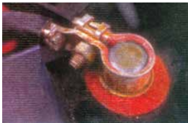
شکل ۱۰-۶ مالیدن گریس به بست باتری
