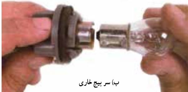
شکل ۵۴-۶- بستن لامپ روی سریچ
