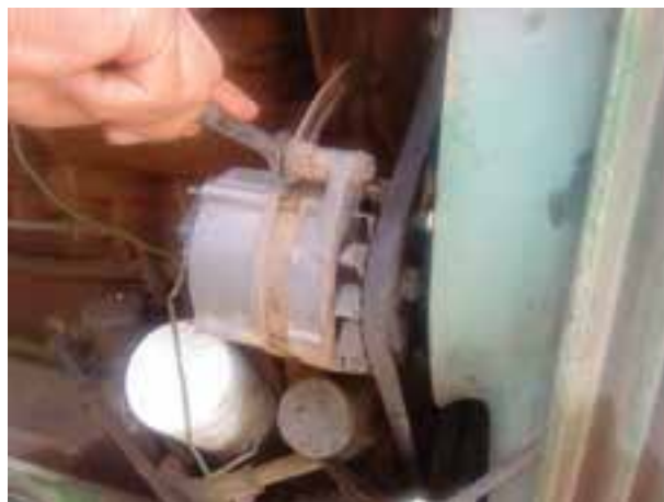
شکل ۳۸-۶ سفت کردن پیچ تنظیم آلترناتور
