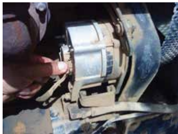
شکل ۲۸-۶- جدا کردن فیش از آلترناتور
