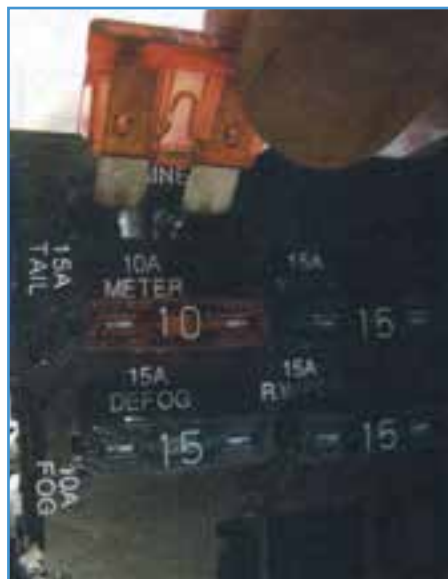
شکل ۶۹-۶- جازدن فیوز در محل آن
