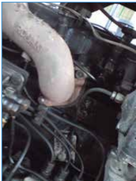
شکل ۳۱-۵- محل اتصال مانیفلد به سرسیلندر تراکتور U650
