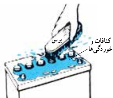
الف) تمیز کردن با برس و آب
