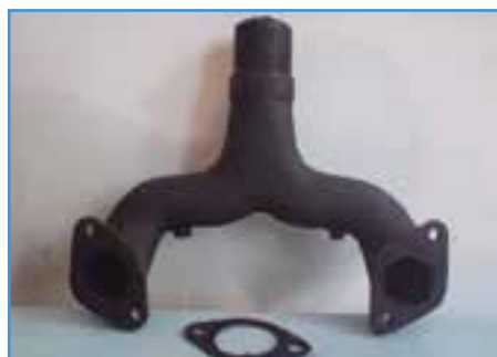
شکل ۲۱-۵- مانیفولد دود تراکتور U650
