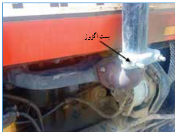
ب) بست اگزوز در تراکتور MF285
