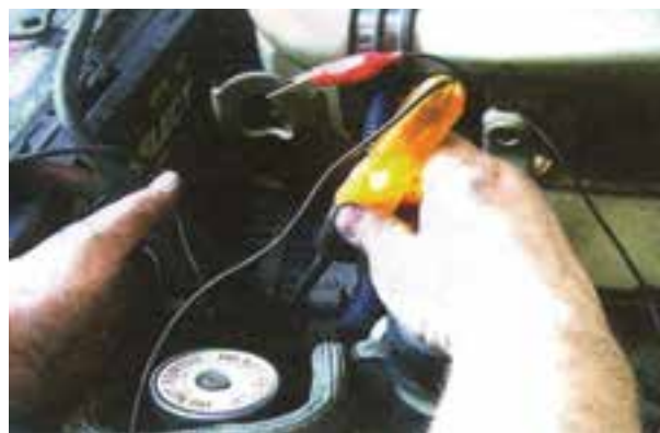
شکل ۷۷-۶ اتصال لامپ آزمایش به مدار
