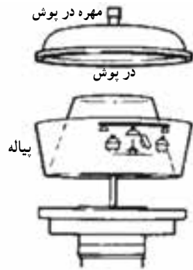
شکل ۳-۵ - قطعات پیش صافی
