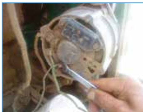
شکل ۳۵-۶ بستن سیم نازک
