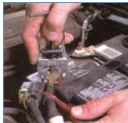
شکل ۸-۶ باز کردن بست مثبت باتری
