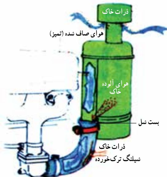
شکل ۱۹-۵- محل بریدگی و سوراخ شدگی در شیلنگ‌ها
