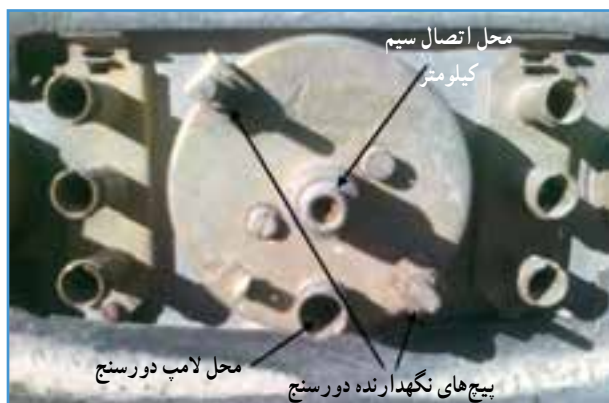
شکل ۸۲-۶ دورسنگ از قسمت پشت داشبورد تراکتور U650M
