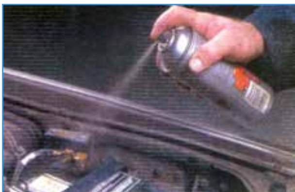
شکل ۱۱-۶ پاشیدن اسپری ضد خوردگی روی بست باتری
