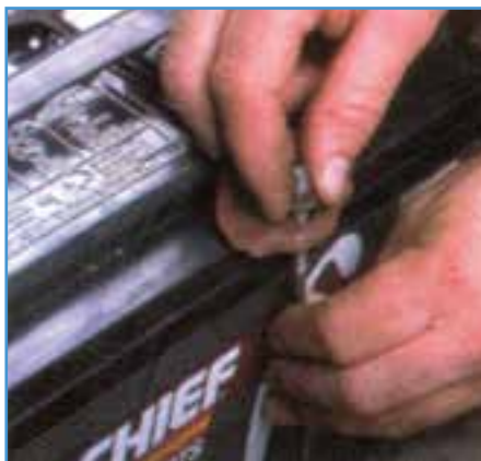
شکل ۹-۶ باز کردن بست نگهدارنده باتری
