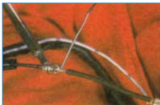
شکل ۶۴-۶- نحوه لحیم کاری سیم ها
