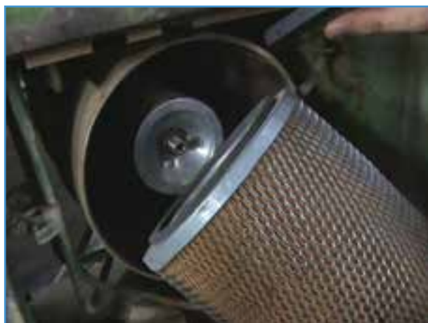
شکل ۵-۵ - صافی خشک و محل قرار گرفتن آن
