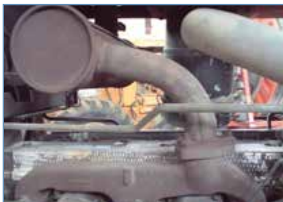
شکل ۳۰-۵- محل اتصال منبع اگزوز به مانیفولد
