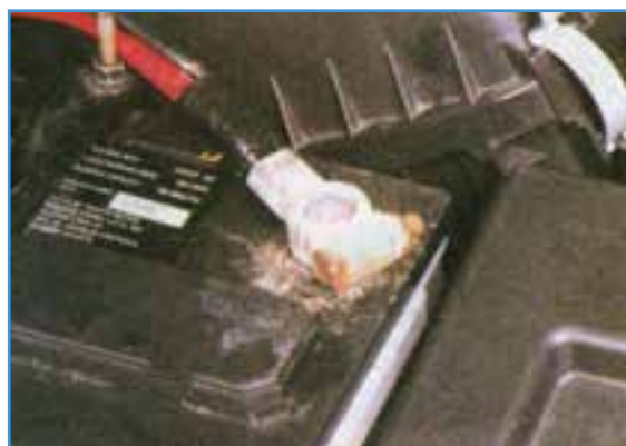
شکل ۲۱-۶- سولفاته کردن بست مثبت باتری
