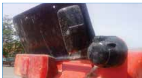
شکل ۱۷-۲- چراغ خطر و ترمز و پریز تریلر تراکتور
