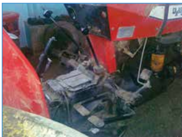
شکل ۲۱-۲- اهرم‌های تعویض دنده و دنده کمک
