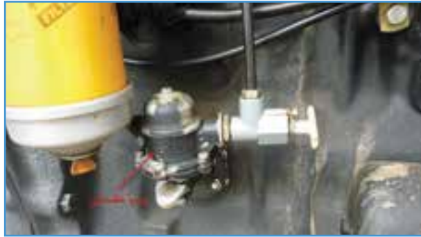
شکل ۲۹-۲- پمپ مقدماتی تراکتور MF285
