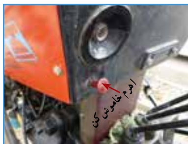
شکل ۱۳-۲ - اهرم خاموش کن تراکتور MF286
