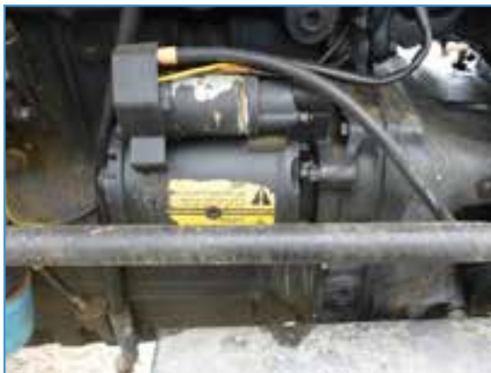
شکل ۲-۴۵- استارت تراکتور MF285
