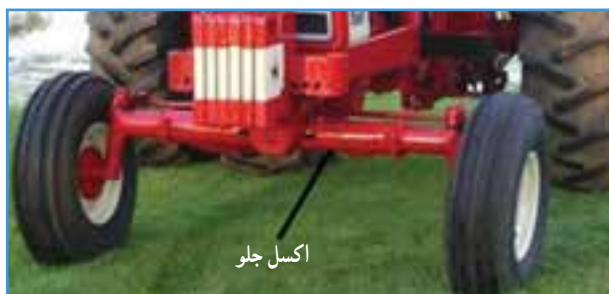
شکل ۲۲-۲- اکسل جلو تراکتور
