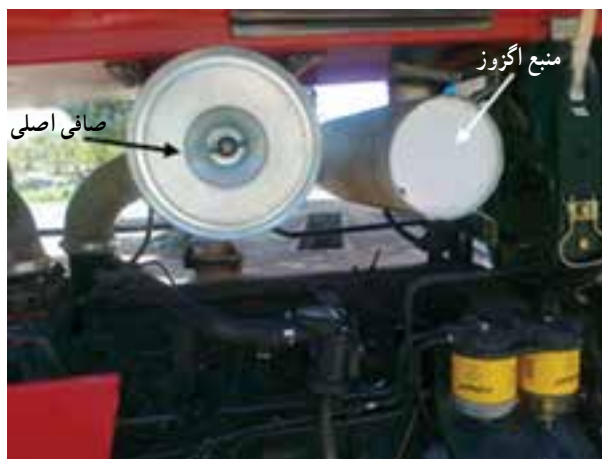
شکل ۲۶-۲- صافی اصلی تراکتور MF399
