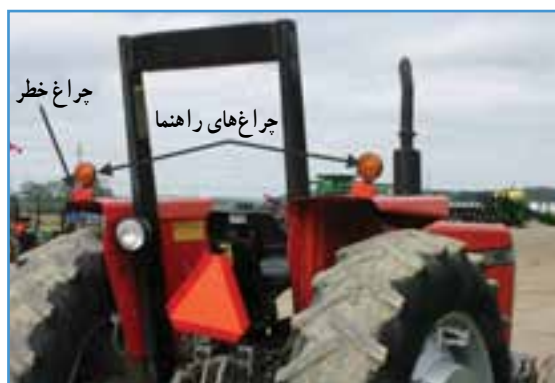
شکل ۱۶-۲- چراغ راهنمای تراکتور MF285
