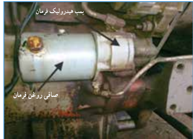
شکل ۲۳-۲- پمپ هیدرولیک فرمان و صافی تراکتور MF285
