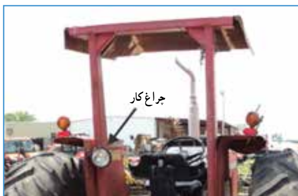
شکل ۱۵-۲- چراغ اصلی عقب تراکتور MF285
