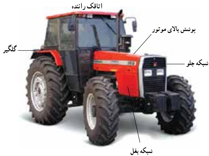
شکل ۲-۲ - بدنه و پوشش‌های تراکتور مسی فرگوسن (MF399)
