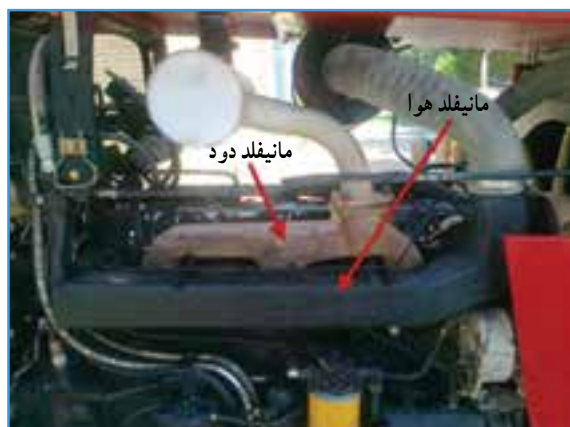
شکل ۲۷-۲- مانیفولد هوا و دود تراکتور MF399
