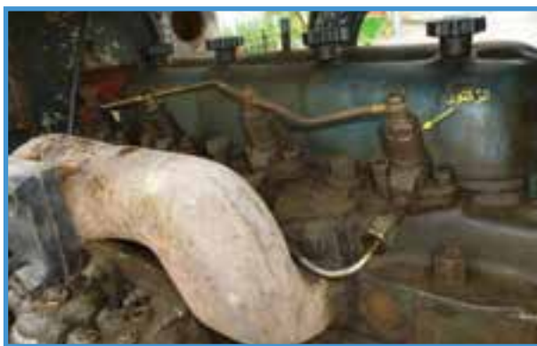
شکل ۳۲-۲- انژکتورهای تراکتور U650M
