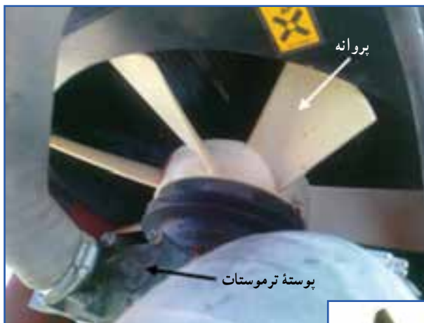
شکل ۳۵-۲ پمپ آب تراکتور
