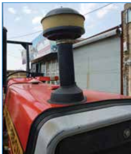
شکل ۲۵-۲- پیش صافی تراکتور MF285
