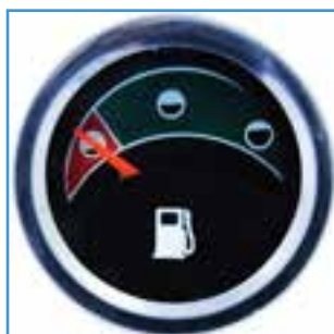
شکل ۹-۲- درجه نشان‌دهنده مقدار سوخت در مخزن سوخت
