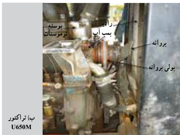
شکل ۳۵-۲ پمپ آب تراکتور
