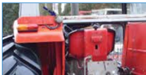
شکل ۱۶-۲- چراغ راهنمای تراکتور MF285
