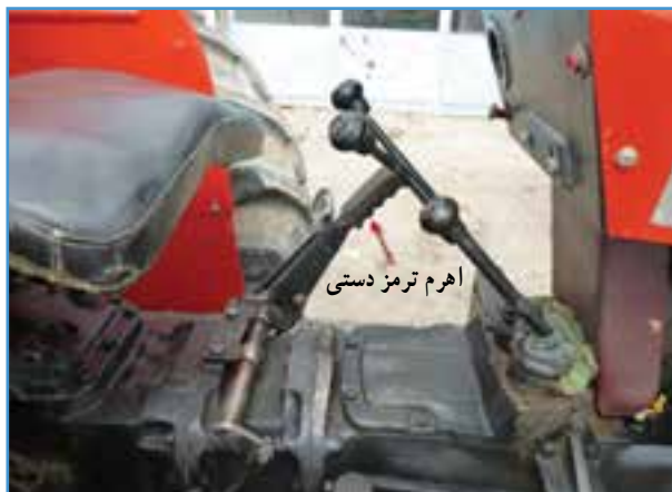
شکل ۱۹-۲ ترمز دستی تراکتور
