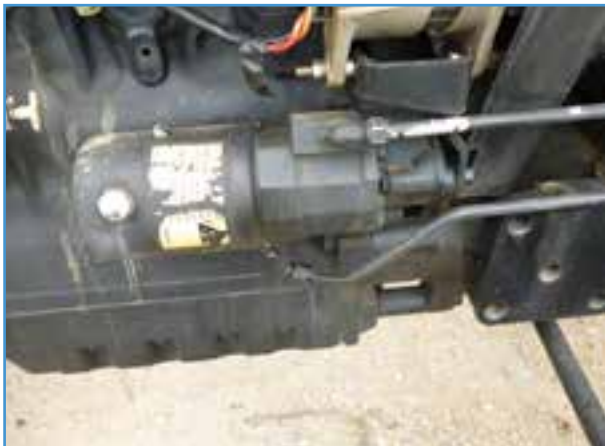
شکل ۲۳-۲- پمپ هیدرولیک فرمان و صافی تراکتور MF285
