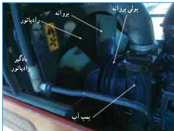
شکل ۳۴-۲ رادیاتور تراکتور MF285
