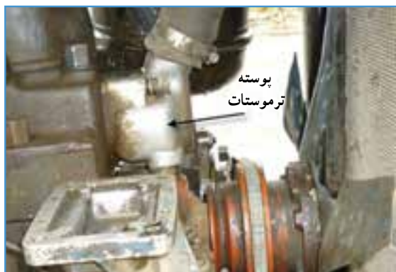
شکل ۳۷-۲ پوسته ترموستات تراکتور U650
