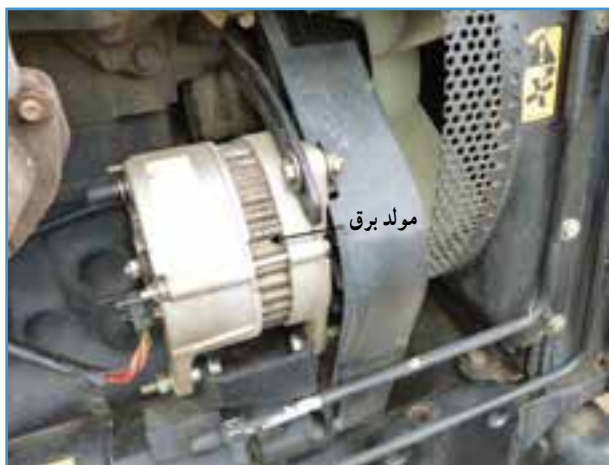
شکل ۴۷-۲- مولد برق تراکتور MF285
