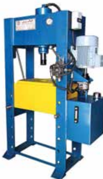
شکل ۷۸-۳- پرس هیدرولیک
