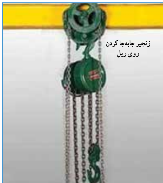
شکل ۲۰-۴ - اتصال جرثقیل سقفی به ریل
