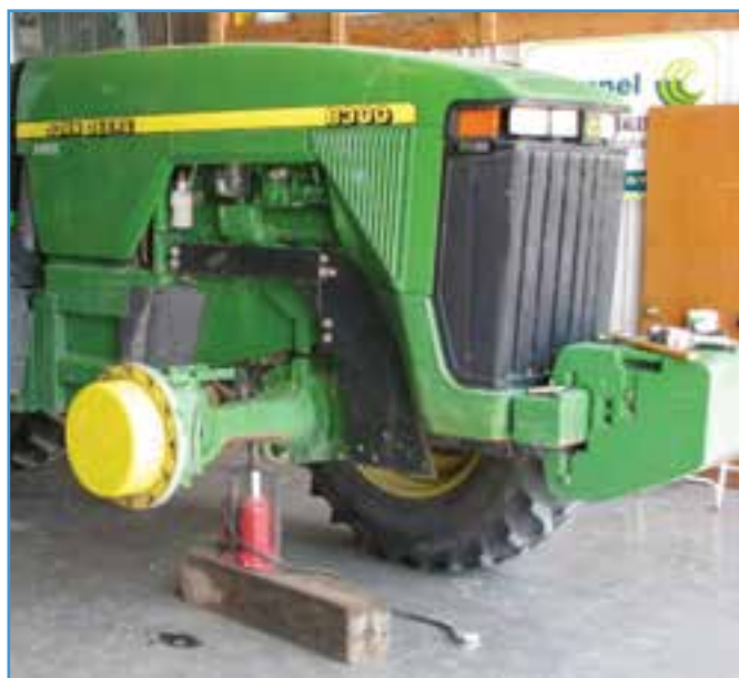
شکل ۱۱-۴- قرار دادن جک روغنی زیر جسم سنگین
