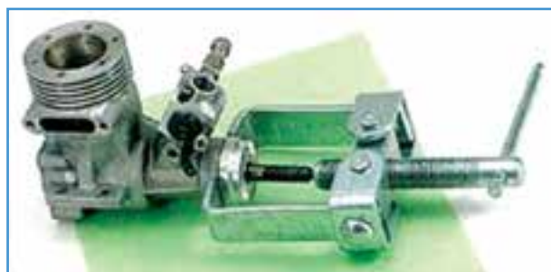
شکل ۷۷-۳- خارج کردن بلبرینگ با بلبرینگ کش
