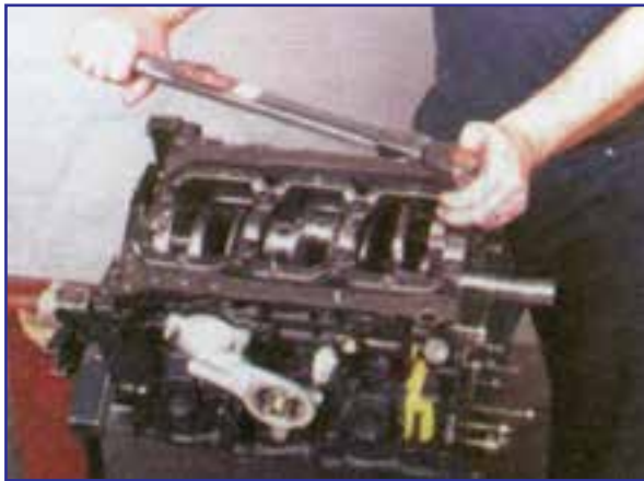
شکل ۳-۵۴- نحوه استفاده از ترک متر خلاصی
