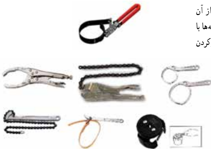
شکل ۶۲-۳- آچار فیلتر بازکن
