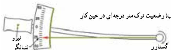
شکل ۳-۵۵- ترک متر درجه ای
