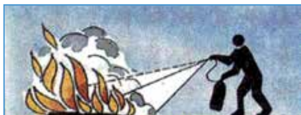
شکل ۱۳-۱- روش خاموش کردن آتش با پودر
