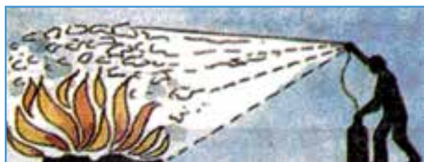
شکل ۱۵-۱- خاموش کردن آتش با کف
