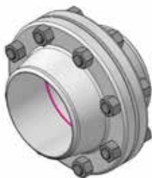
شکل ۳-۱- کاربرد پیچ و مهره برای اتصال
