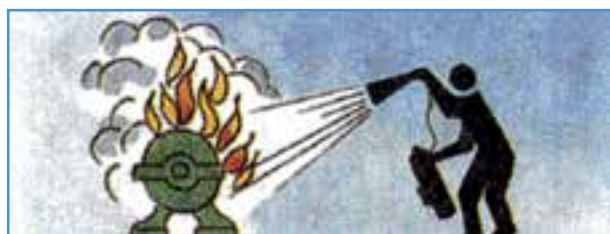
شکل ۱۴-۱- خاموش کردن آتش با دی اکسید کربن
