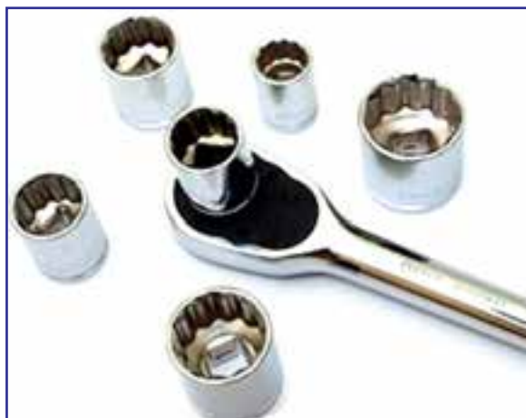
شکل ۴۸-۳ اتصال بکس به دسته بکس جفجغه ای
