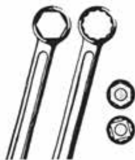
شکل ۳۰-۳- آچار رینگ با سر شش و دوازده گوش
