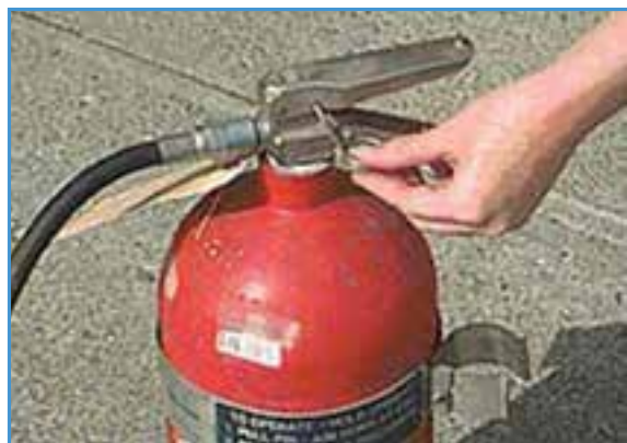
شکل ۱۱-۱- نحوه خارج کردن ضامن کپسول
