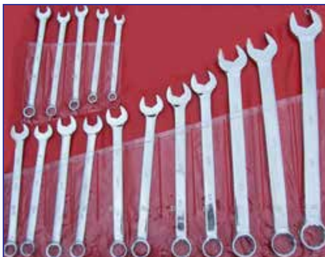
شکل ۳۳-۳- یک سری آچار یک سر رینگ
