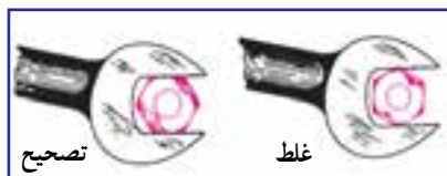
شکل ۲۹-۳ طرز درگیر کردن آچار تخت با مهره
