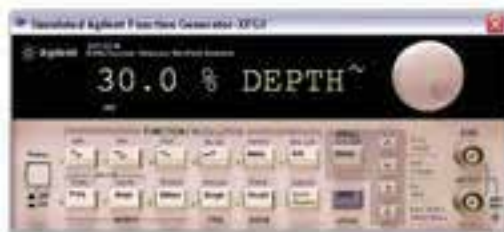
شکل ۵-۲ تنظیم درصد مدولاسیون در حالت AM
