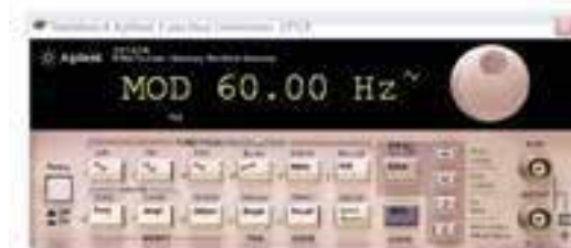
شکل ۲-۱۵ چگونگی تنظیم شاخص مدولاسیون در حالت FM
