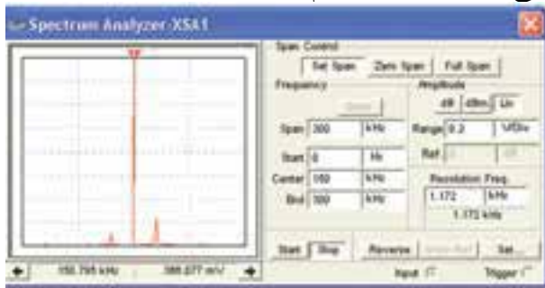
شکل ۲۳-۱ مشاهده‌ی مدار مولد موج AM
