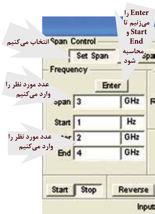
شکل ۶-۱ تنظیم جابه‌جایی در جهت افقی با استفاده از Span Control
