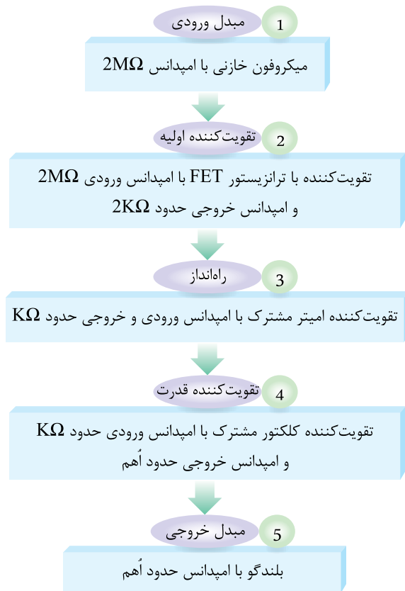
شکل ۴-۴- بلوک دیاگرام اتصال چند طبقه تقویت کننده به هم
