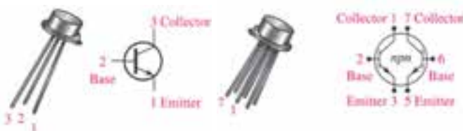
(ب) ترانزیستور در بسته دوتایی (ت) ترانزیستور با بسته‌بندی TO ۱۸
