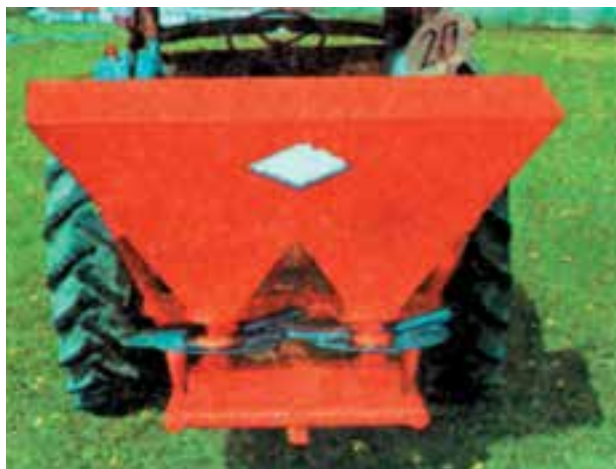
شکل ۱-۲- بذریاش سانتریفوژ با دو صفحه پرتاب کننده
