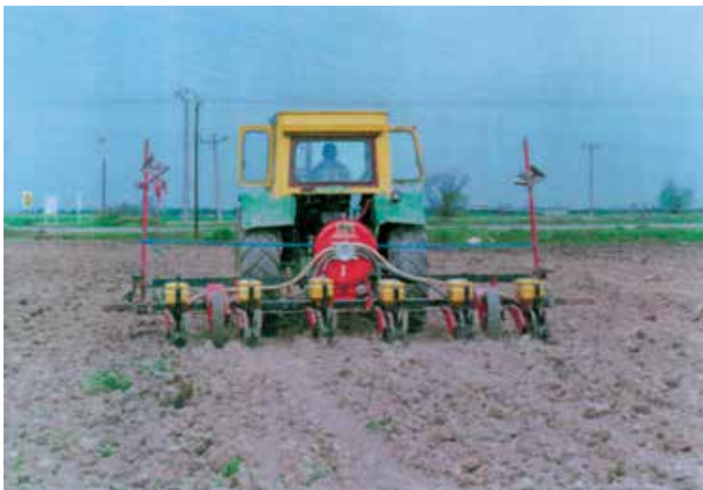
شکل ۴-۶- کاشت آفتابگردان با بذركار پنوماتيكي
