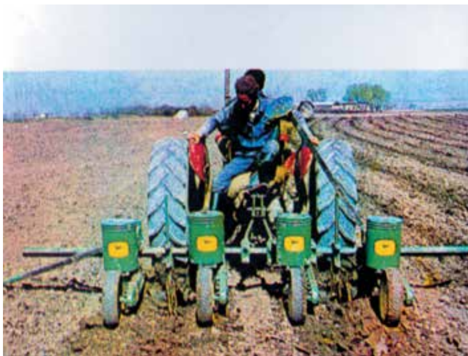
شکل ۵-۴ کاشت با استفاده از ردیفکار مکانیکی
