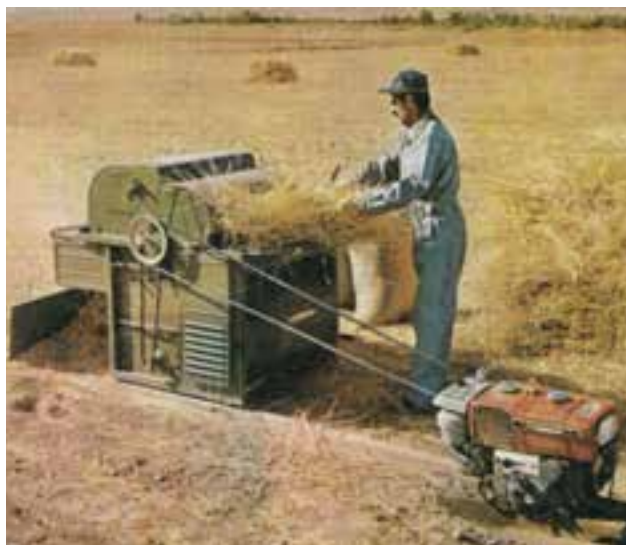
شکل ۲۳-۱- خرمنکوب با موتور تیلر در حال کار
