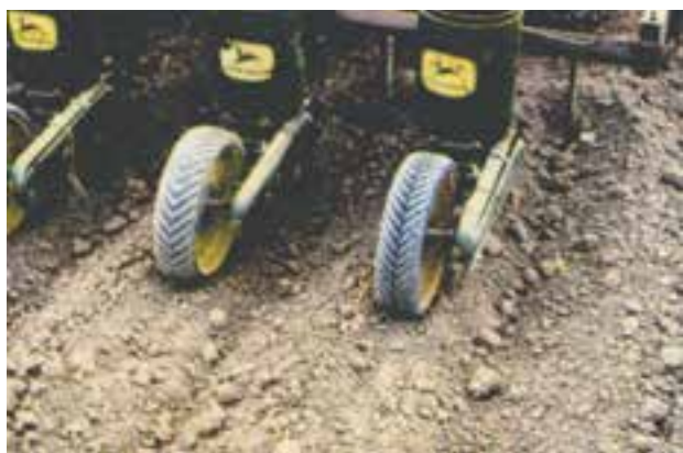
شکل ۵-۳- نحوه تنظیم بذرافشان تراکتوری در اراضی شور
