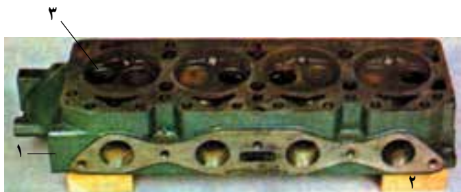
۱- سرسیلندر ۲- قطعه چوب ۳- نشیمنگاه شکل ۱۵-۸
