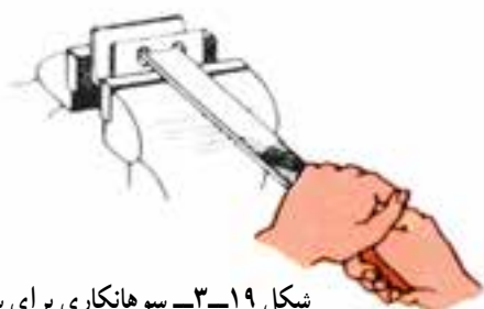
شکل ۳-۱۸ - کارهای کوچک و براده برداری مختصر
