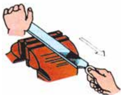
شکل ۳-۲۵ - حرکت به عقب بدون فشار
