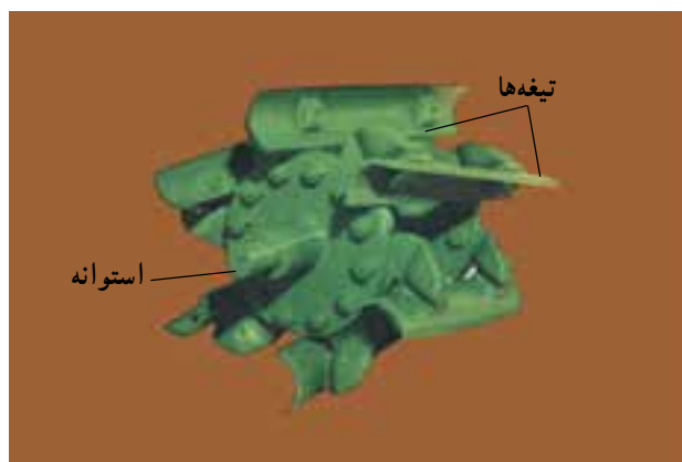
شکل ۳-۲- استوانه خردکننده به همراه تیغه‌ها
