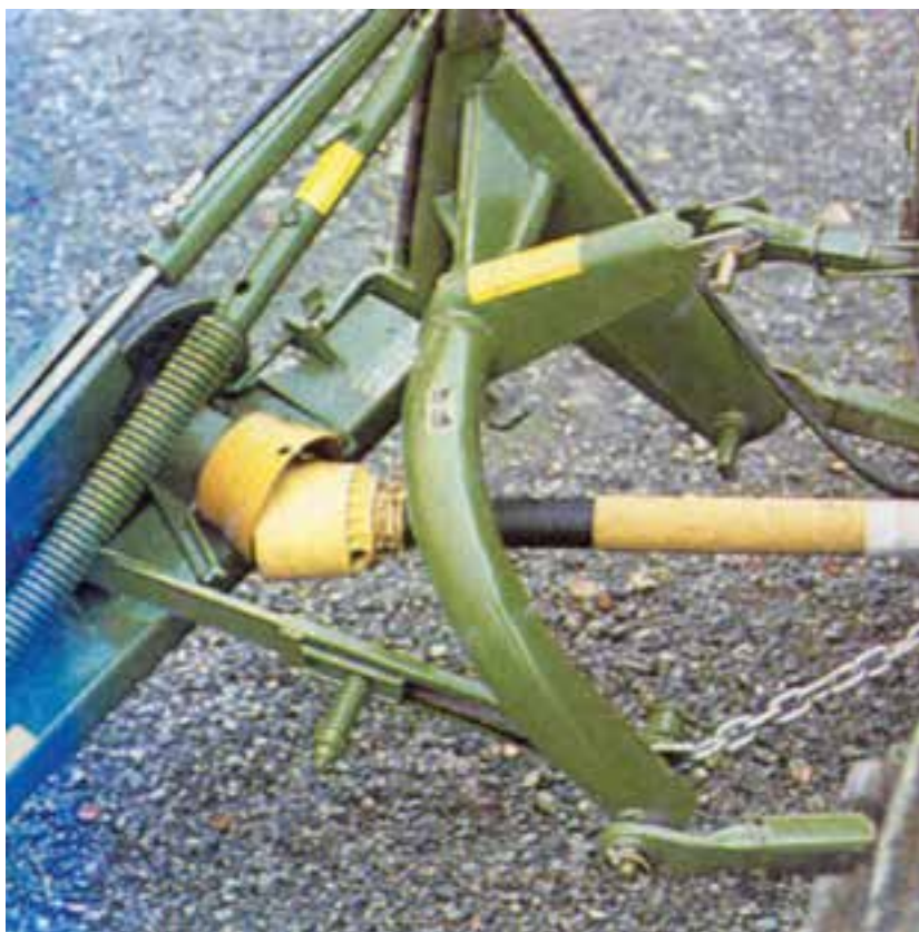
شکل ۱۳-۱۰ اتصال بازوهای تراکتور به دروگر بشقابی
