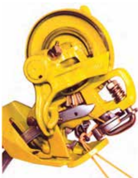
۲۸ x ۲۹ - ۱ - تسمه ترمز - F - فنر فشار شکل ۳-۳۵
