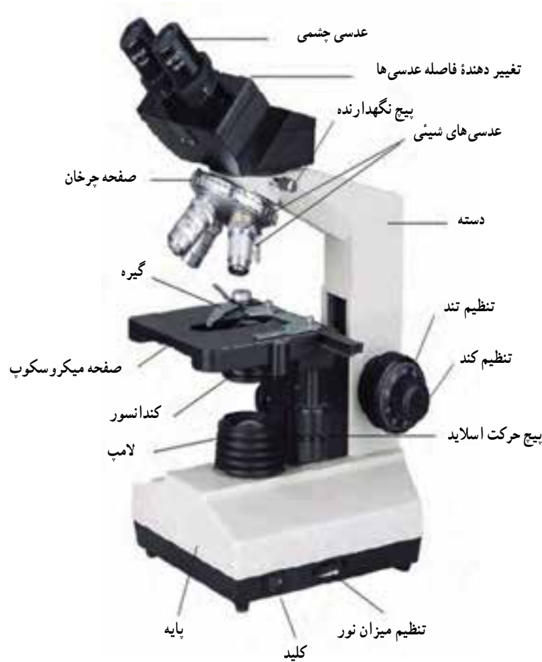
شکل ۴-۲- بخش‌های اصلی یک میکروسکوپ نوری
