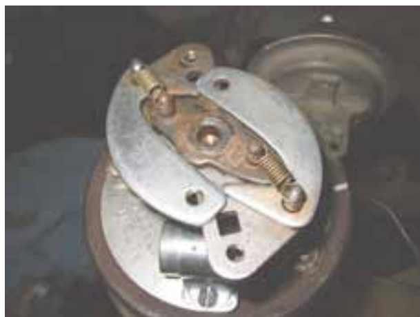
شکل ۲۴-۱۰- دستگاه آوانس وزنه‌ای دلکو
