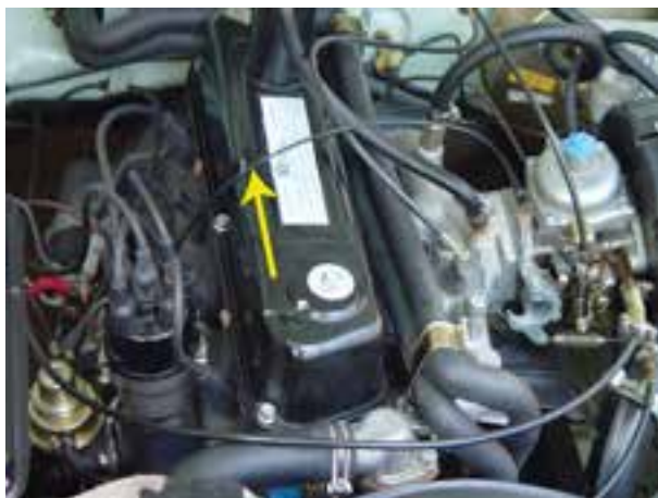
شکل ۲۸-۱۰ لوله‌ی رابط آوانس خلئی به کاربراتور
