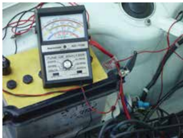
شکل ۱۰-۱۳- مقادیر زاویه‌ی نشست پلاتین (داول)
