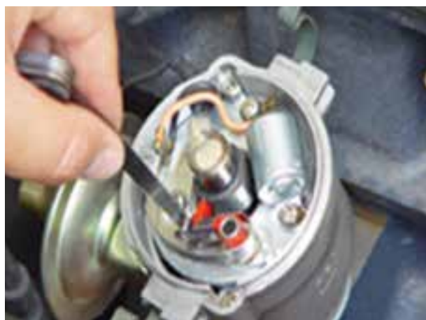
شکل ۴۸-۱۰- قرار دادن فیلر در دهانه‌ی پلاتین
