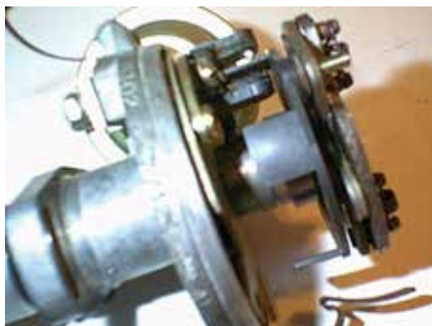
شکل ۷۳-۱۰- دلقوی الکترونیکی با حسگر اثرهال
