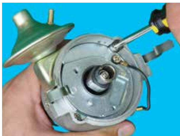
شکل ۱۹-۱۰- باز کردن پیچ‌های صفحه‌ی دلکو
