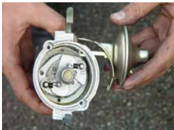
شکل ۳۱-۱۰ جدا کردن مجموعه‌ی آوانس خلئی
