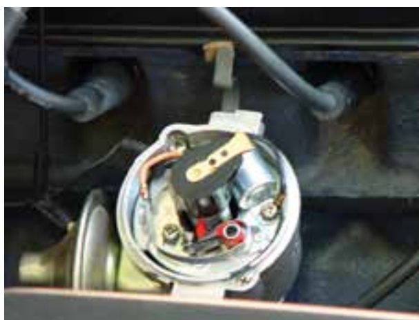
شکل ۵۵-۱۰- راستای چکش برق به سمت سیلندر یک
