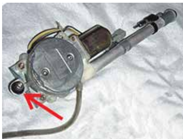
شکل ۵-۲۲- آنتن الکتریکی پس از پیاده کردن آن
