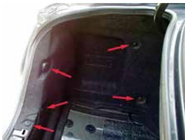
شکل ۲۰-۵- خارهای پلاستیکی کاور صندوق عقب
