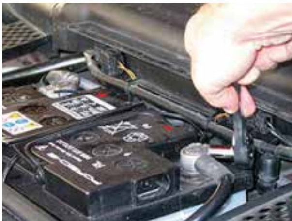
شکل ۱۸-۵- باز کردن کابل اتصال بدنه‌ی باتری
