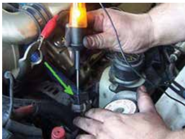
شکل ۱-۷۳- آزمایش سیم‌کشی مدار
