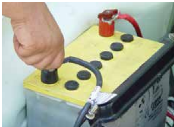
شکل ۱-۴۹- باز کردن اتصال بدنه باتری
