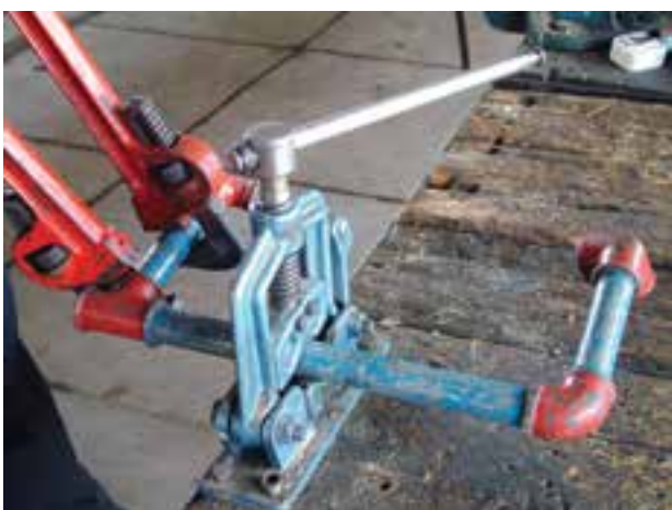
شکل ۵-۱۵۶- بستن ضلع سوم مدار به سه‌راهی
