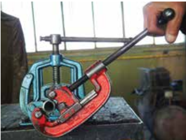
شکل ۱۵۰-۵- بریدن لوله ها
