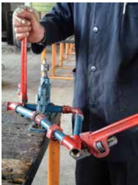
شکل ۱۴۲-۵- جا انداختن قطعات مهره ماسوره در درون یک دیگر به وسیله ی گرداندن هم زمان سه راهی ها
