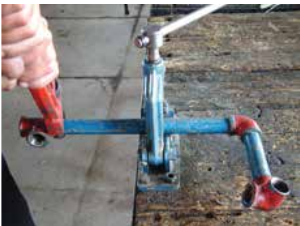
شکل ۵-۱۵۵- بستن سه‌راهی به ضلع دوم مدار
