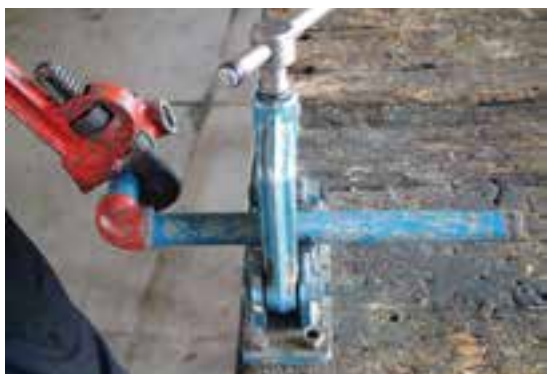
شکل ۱۵۴-۵- بستن لوله‌ی ضلع دوم مدار
