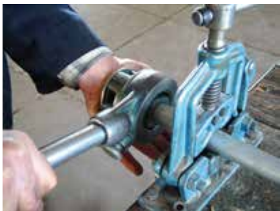
شکل ۱۵۱-۵- حدیده کردن لوله‌ها
