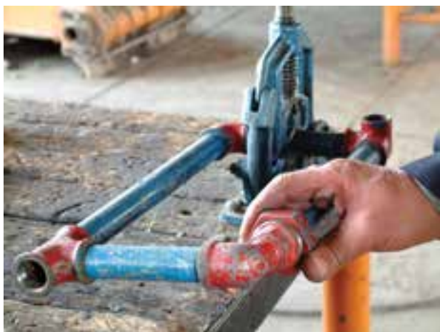
شکل ۱۶۰-۵- بستن مهره ماسوره به وسیله ی دست
