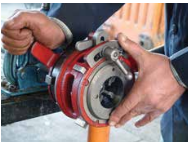
شکل ۴-۱۱۴- سفت کردن فلکه‌ی چهار نظام
