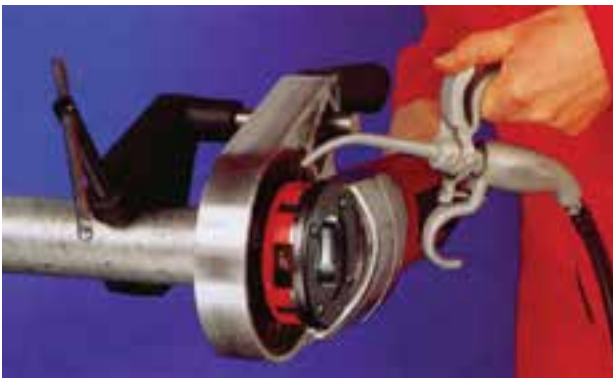
شکل ۴-۱۰۸- استفاده از روغن‌دان در جریان لوله‌کشی
