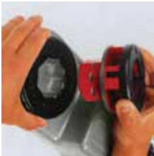
شکل ۱۰۴-۴ - تعویض پارچه‌های حدیده
