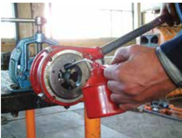
شکل ۴-۱۱۵- استفاده از روغن دان در جریان حدیده کاری
