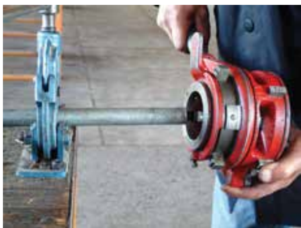
شکل ۴-۱۱۹- بستن لوله به گیره و قراردادن حدیده بر روی آن
