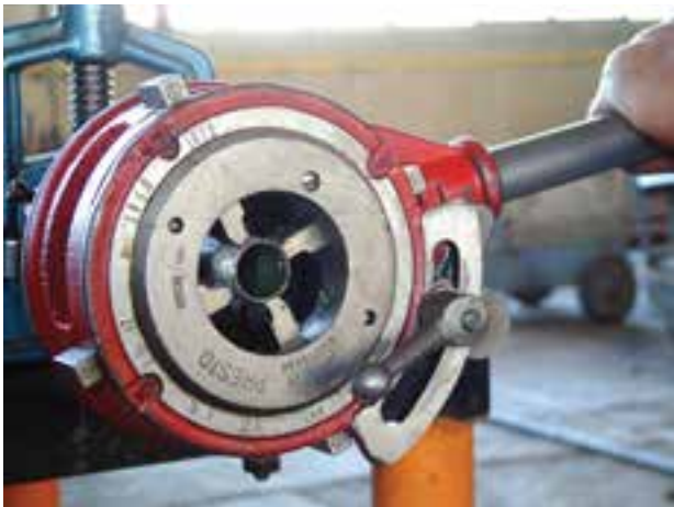
شکل ۴-۱۲۴- عمل حدیده کاری تا عبور پارچه‌ها از لبه‌ی لوله
