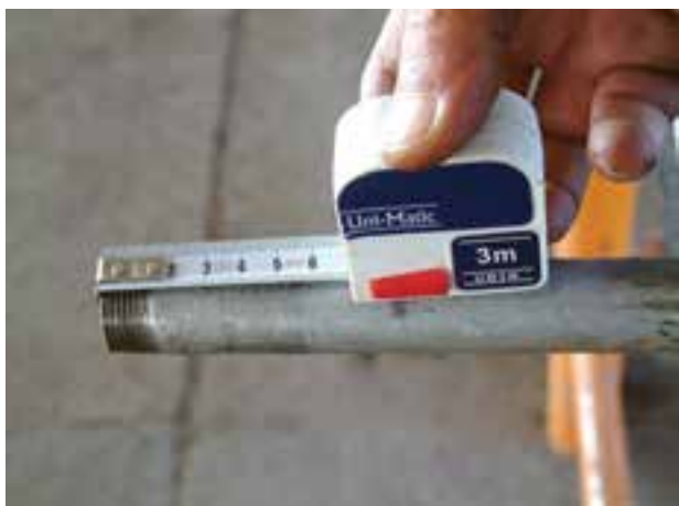
شکل ۱۲۸-۴- اندازه‌گیری لوله‌ی حدیده شده
