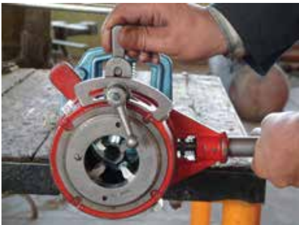
شکل ۴-۱۲۵- کم کردن بار پارچه‌های حدیده
