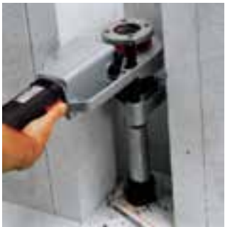
شکل ۱۰۵-۴ - طرز استفاده از حدیده
