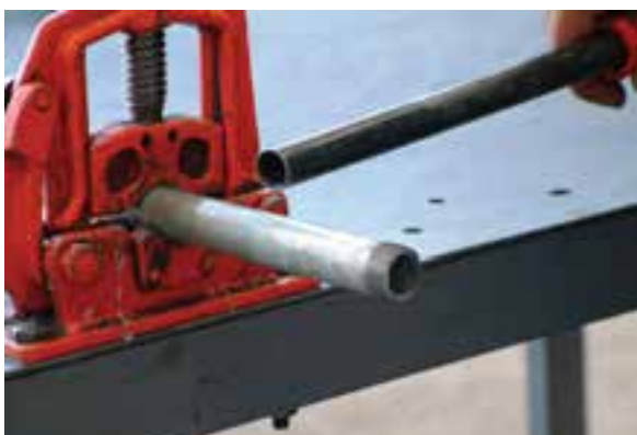
شکل ۴-۱۱۷ جداسازی پلیسه از سر دنده
