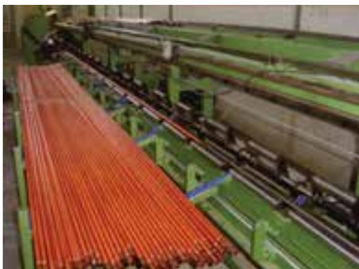
شکل ۹-۵- لوله‌ی مسی به صورت شاخه‌ای
