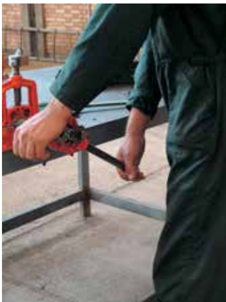
شکل ۴-۱۱۲- حدیده‌ی متناسب با قطر لوله
