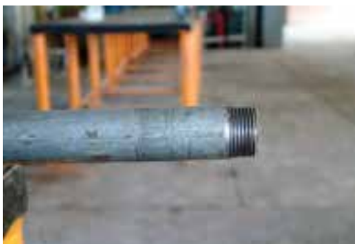
شکل ۴-۵- لوله‌ی فولادی گالوانیزه
