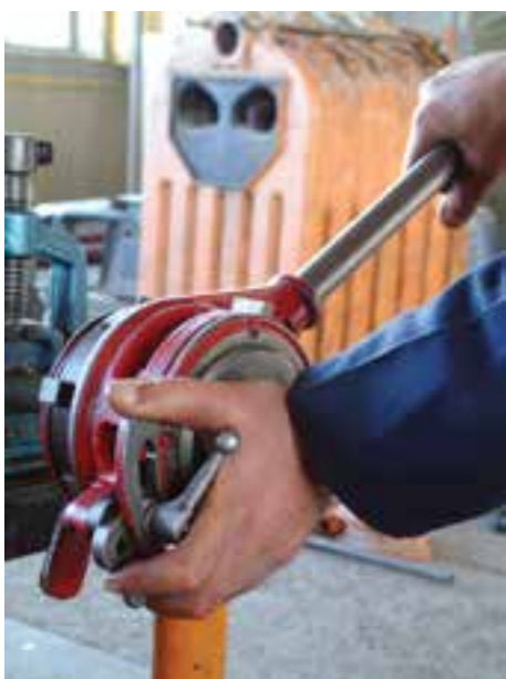
شکل ۴-۱۲۲- عمل درگیر کردن پارچه‌ها با سر لوله
