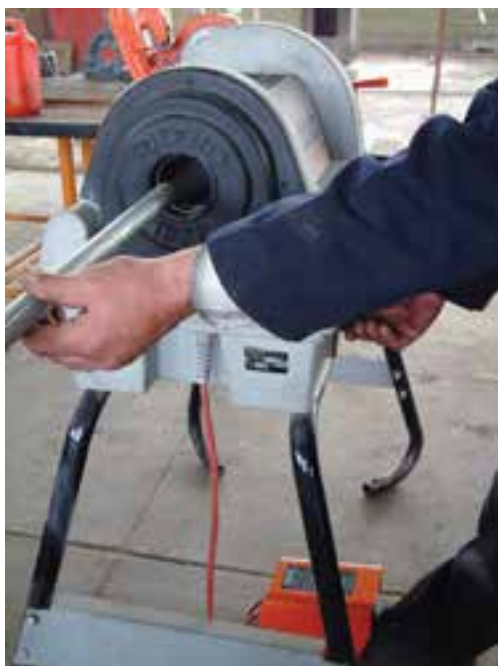
شکل ۱۳۱-۴- قراردادن لوله در حدیده‌ی ماشینی
