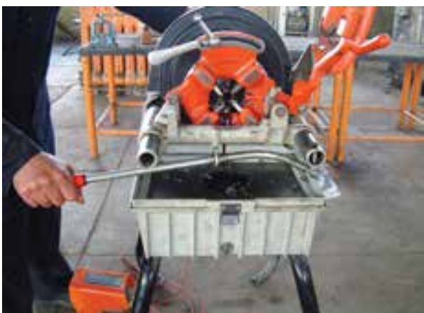
شکل ۱۳۳-۴ عمل حدیده کاری لوله
