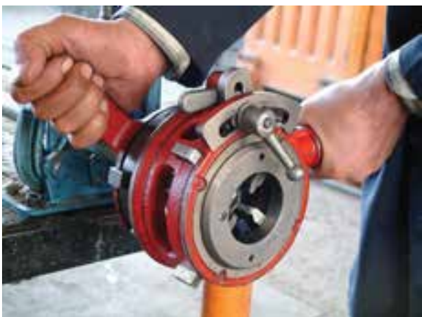
شکل ۴-۱۲۰- بستن اهرم فلکه‌ی چهار نظام
