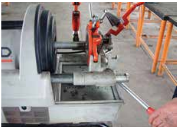
شکل ۴-۱۴۰- پایان عمل حدیده کاری
