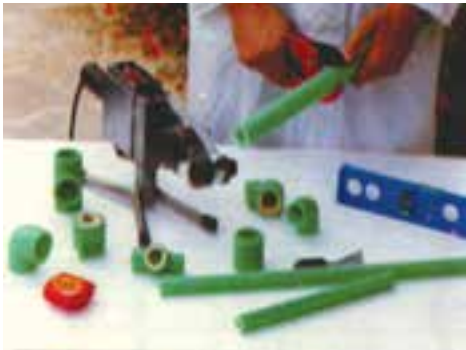
شکل ۲۷-۵- بریدن لوله به وسیله‌ی قیچی مخصوص
