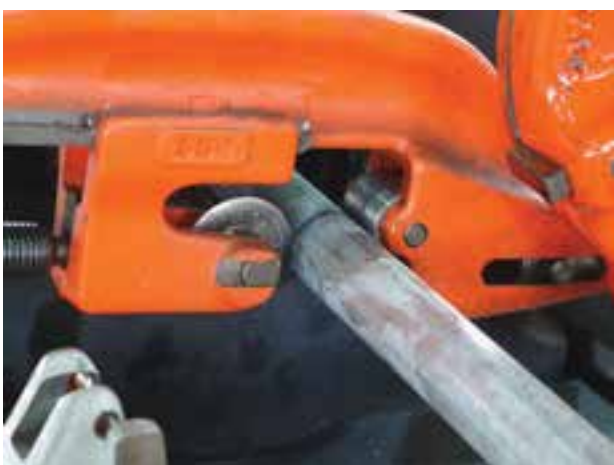
شکل ۴-۱۳۷- بریدن لوله به وسیله ی لوله بُر
