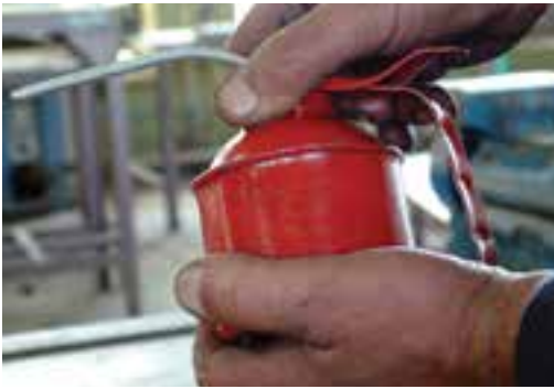
الف - باز کردن پمپ از مخزن روغن
