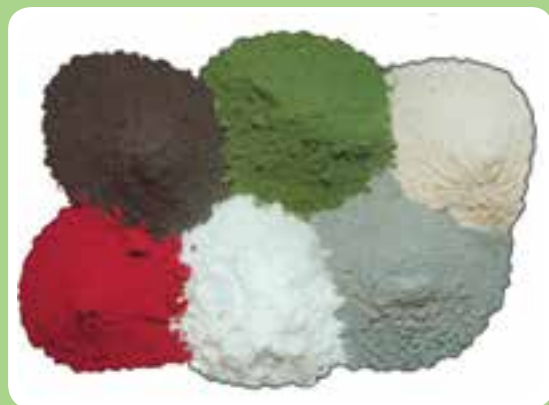
مواد پودری تشکیل دهنده روپوش الکتروود
