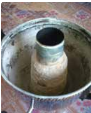
شکل ۸-۵- تشکیل رسوب در سماور و لوله‌ها
