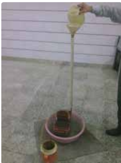
شکل ۱۷-۵- اسید خروجی از ظرف دوم باید بدون کف باشد.
