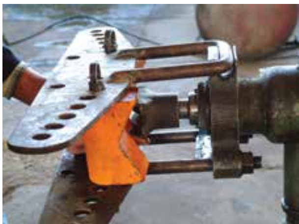
شکل ۳-۵۵- قرار دادن پارچه‌ی خم کن \frac{1}{4} و لقمه‌ها در جای خود
