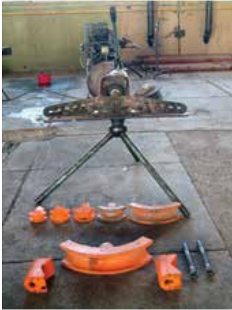
شکل ۱۳-۳- اجزای خم کن هیدرولیکی
