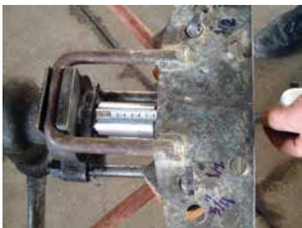
شکل ۳-۲۷- اندازه‌گیری طول بیستون خارج شده از سیلندر
