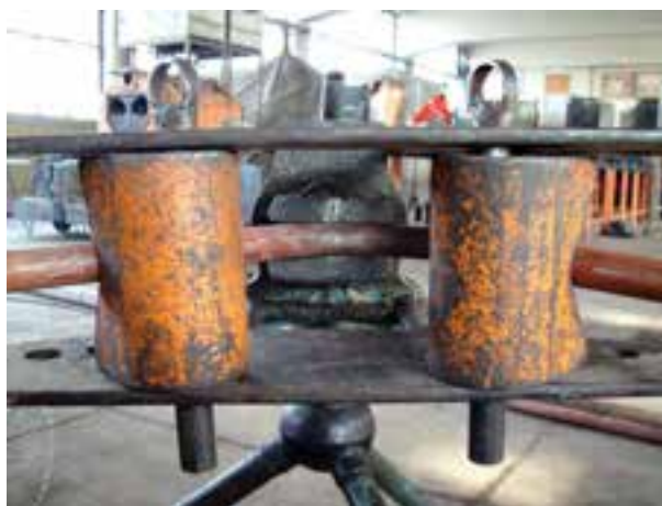
الف- باز کردن خم لوله‌ی خم شده
