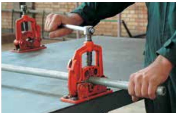
شکل ۳-۵۳- باز کردن شاخه‌ی لوله از گیره‌ی لوله
