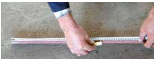
شکل ۳-۵۴- خط کشی لوله و تعیین محل‌های خم
