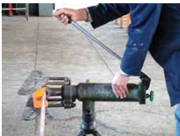
شکل ۱۱-۳- شروع خم کاری
