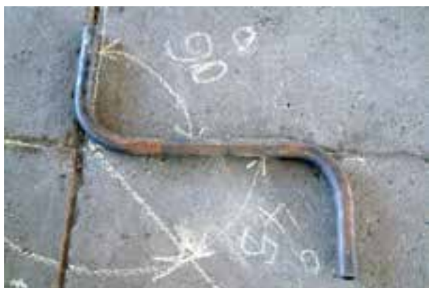
شکل ۳-۴۱- عدم دویدگی لوله‌ی دو خم
