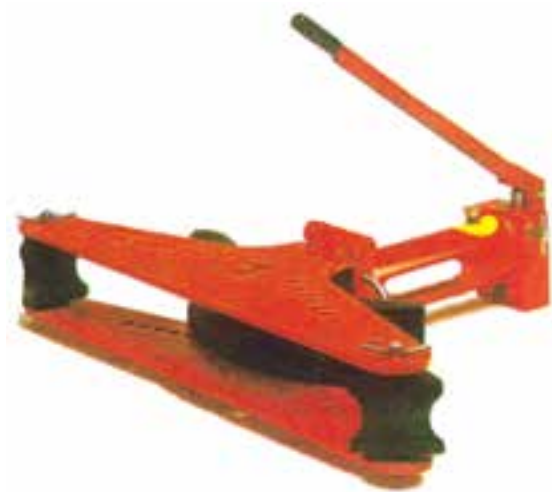
شکل ۱۰-۳- خم کن هیدرولیکی
