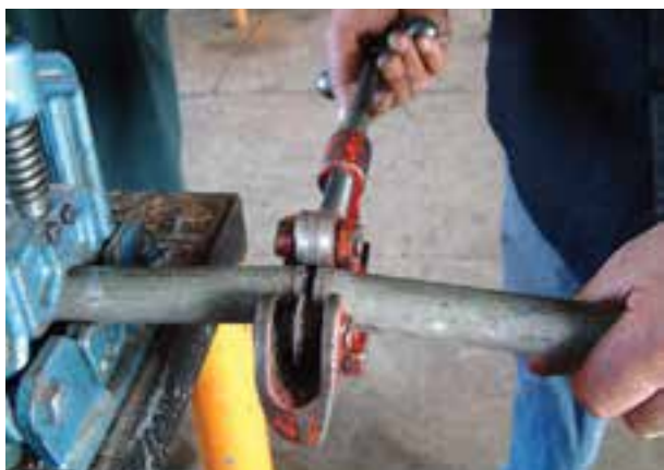
شکل ۳-۵۲- بریدن لوله‌ی محاسبه شده
