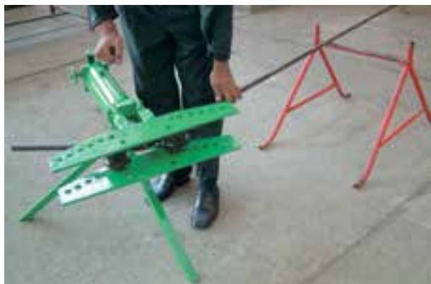
شکل ۳-۴۲- استفاده از خرک در خم‌کاری
