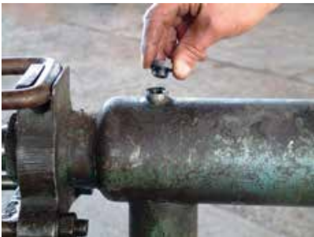
شکل ۱۵-۳- سرپوش مجرای ورودی روغن
