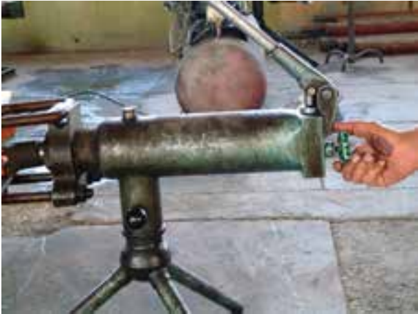
شکل ۳-۲۳- بستن شیر قطع و وصل
