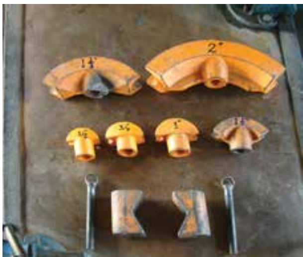
شکل ۳-۲۰- پارچه‌ها و لقمه‌های خم‌کن هیدرولیکی
