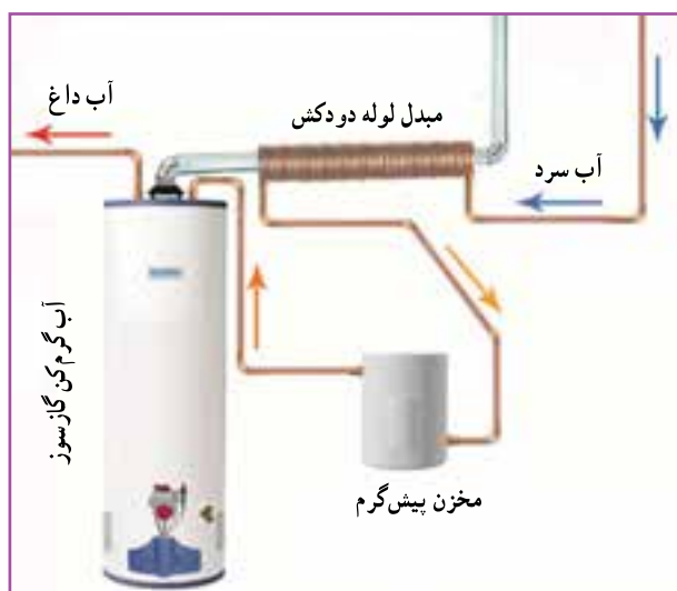
شکل ۳-۱۴ مبدل گرمایی (پیش گرم کن) گاز به مایع
